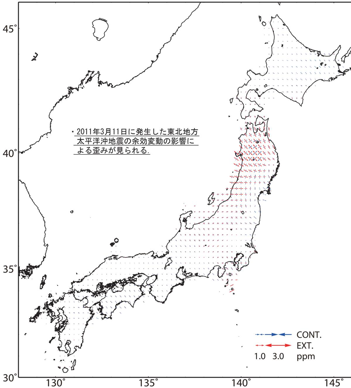
G N S S 座標値データに基づいて1年間の歪み変化図を作成した。座標値の15日分の平均値から1年間の変位ベクトルを算出し、それに基づいて歪みを計算している。
