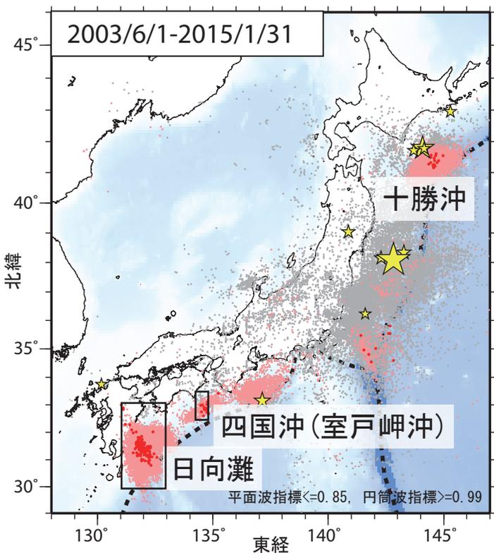
第1図. 2003年6月1日から2015年1月31日までの期間にアレイ解析によって検出されたイベントの震央分布. 検出イベントを防災科研Hi-netの手動検測震源と照合し, 対応する地震が見出されたイベントを灰色で, それ以外を桃色(2014年10月31日以前), および赤色(11月1日以降)の点でそれぞれ示す. これらは主として周期10秒以上に卓越する超低周波地震を表すが, 東北地方太平洋沖地震の発生以降は, 除去しきれない通常の地震を多数含む. 期間内に発生したM7以上の地震の震央を黄色星印で併せて示す(ただし, 2011年3月11日以降は東北地方太平洋沖地震の本震のみ).
