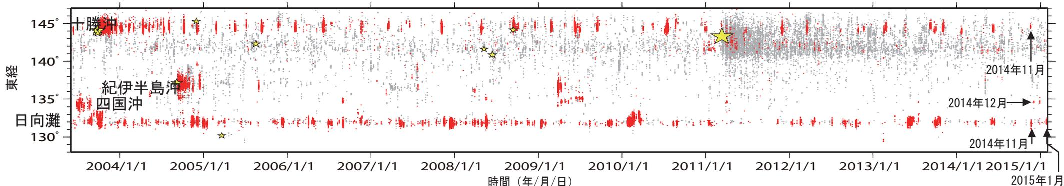
第3図. 2003年6月1日から2015年1月31日までの期間に検出されたイベントの時空間分布. 検出されたイベントを防災科研Hi-net手動検測震源と照合し, 対応する地震が見出されたイベントを灰色で, それ以外を赤色の点でそれぞれ示す. その他は第1図に同じ.
