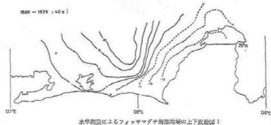
第8図 水準測量によるフォッサマグナ南部地域の上下変動図
