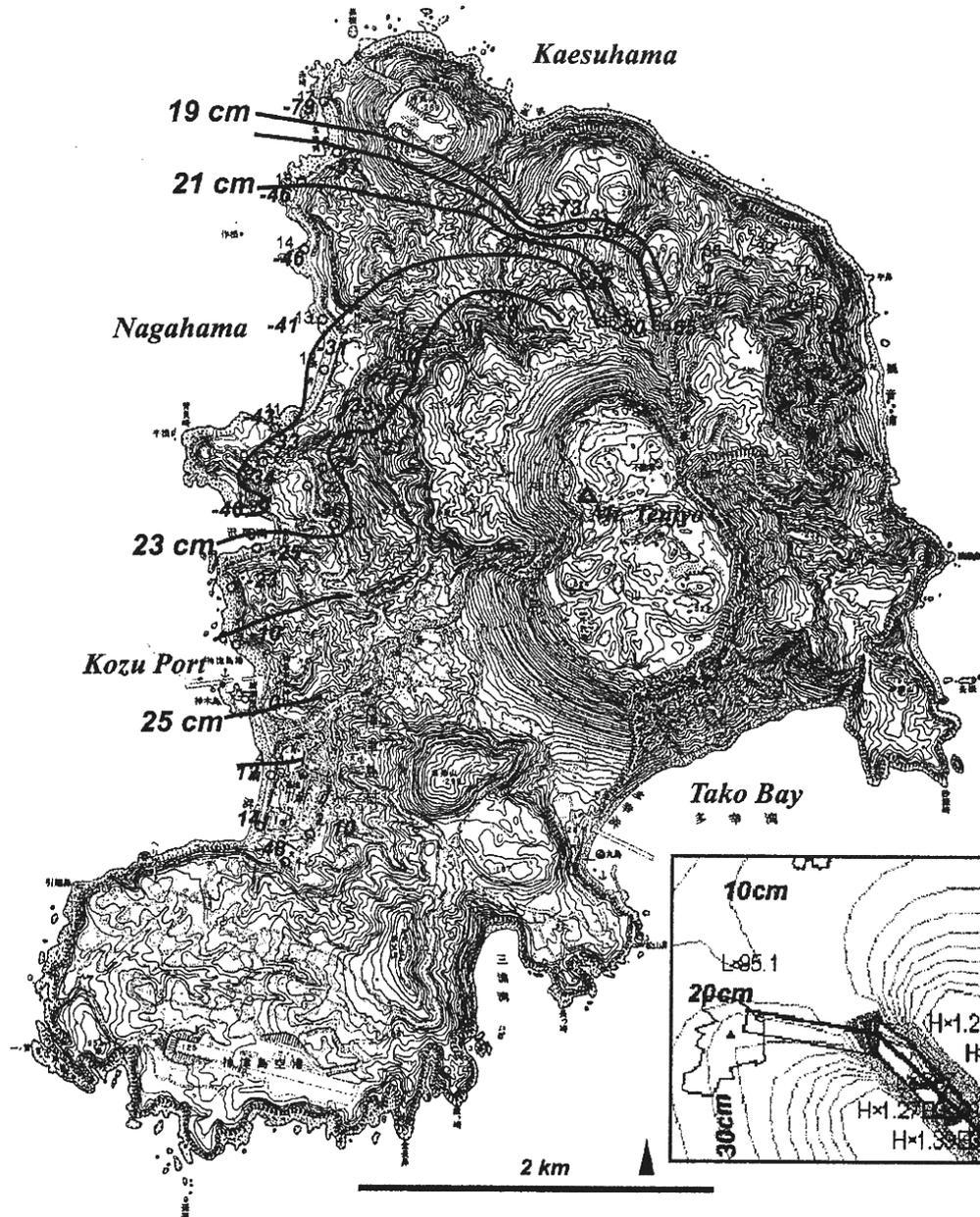
第 1 図 神津島における水準点の位置と地殻上下変動 (2000 年 1 月～2001 年 4 月) 水準点番号脇に記す変動量 (mm、BM4 に対する変動量)、コンターは BM4 (神津港験潮所) の南伊豆に対し 25cm 隆起 (水路部の潮位・GPS 観測結果) を加算して示す。水準点 37 以東は 2001 年 4 月に通行不可能だった。
