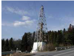
上：屏風山 1,000m ボアホール掘削および計器埋設設置に用いられた掘
