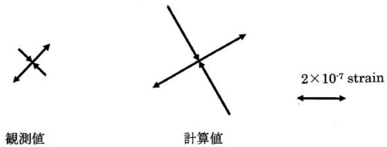
第 6 図 4 月の活動時の歪変化（観測値）と第 5 図に示す岩脈貫入モデルから求まる歪変化（計算値）。
