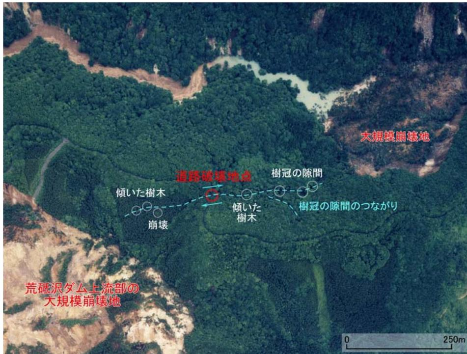
図6 荒砥沢ダム上流部の大規模崩壊地の北東部の地表変状
