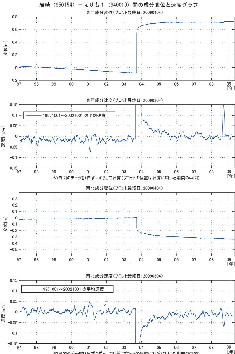
第6図 北海道太平洋岸のGEONET観測点における地殻変動速度の変化
