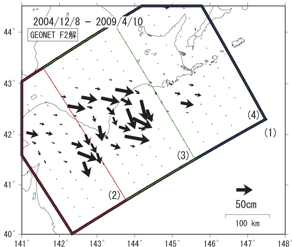
第8図a 時間発展インバージョンにより推定した2004年12月6日の釧路沖地震以降における北海道東部のプレート間滑り(滑り分布)
