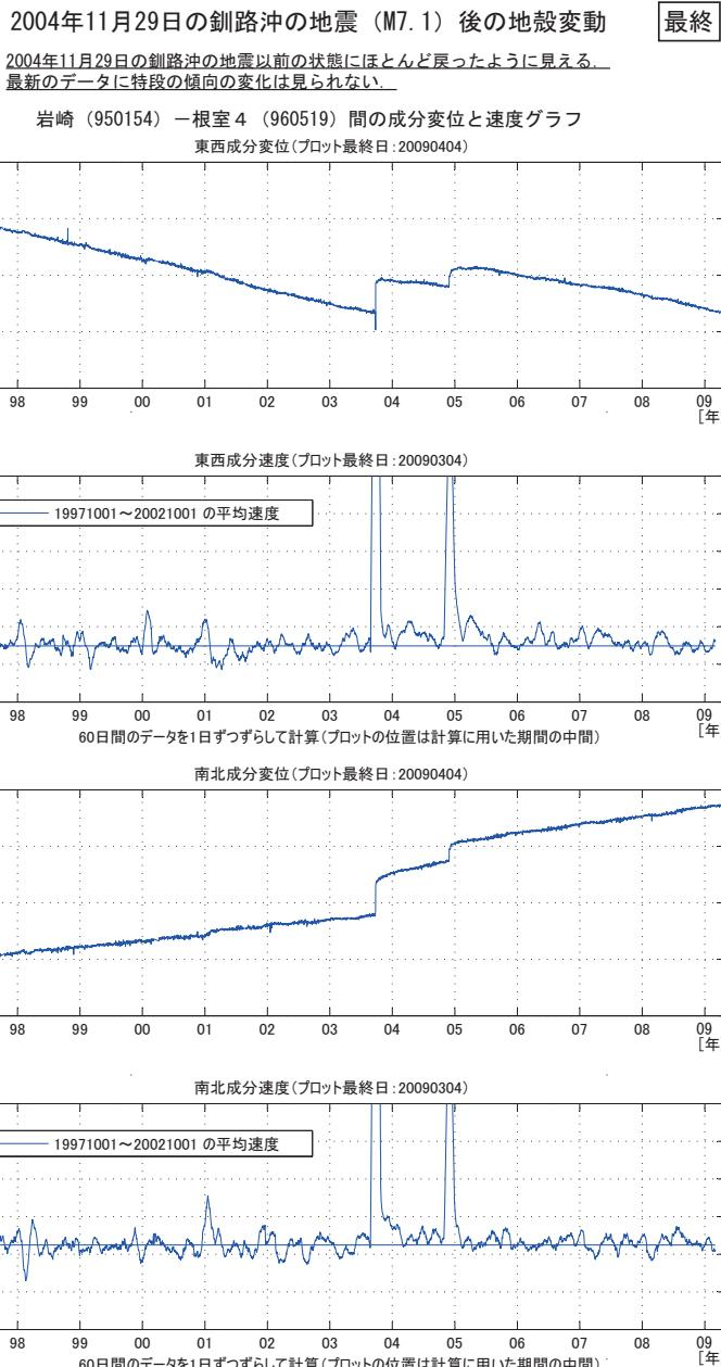
第7図 北海道太平洋岸のGEONET観測点における地殻変動速度の変化(根室 4 観測点・時系列)
