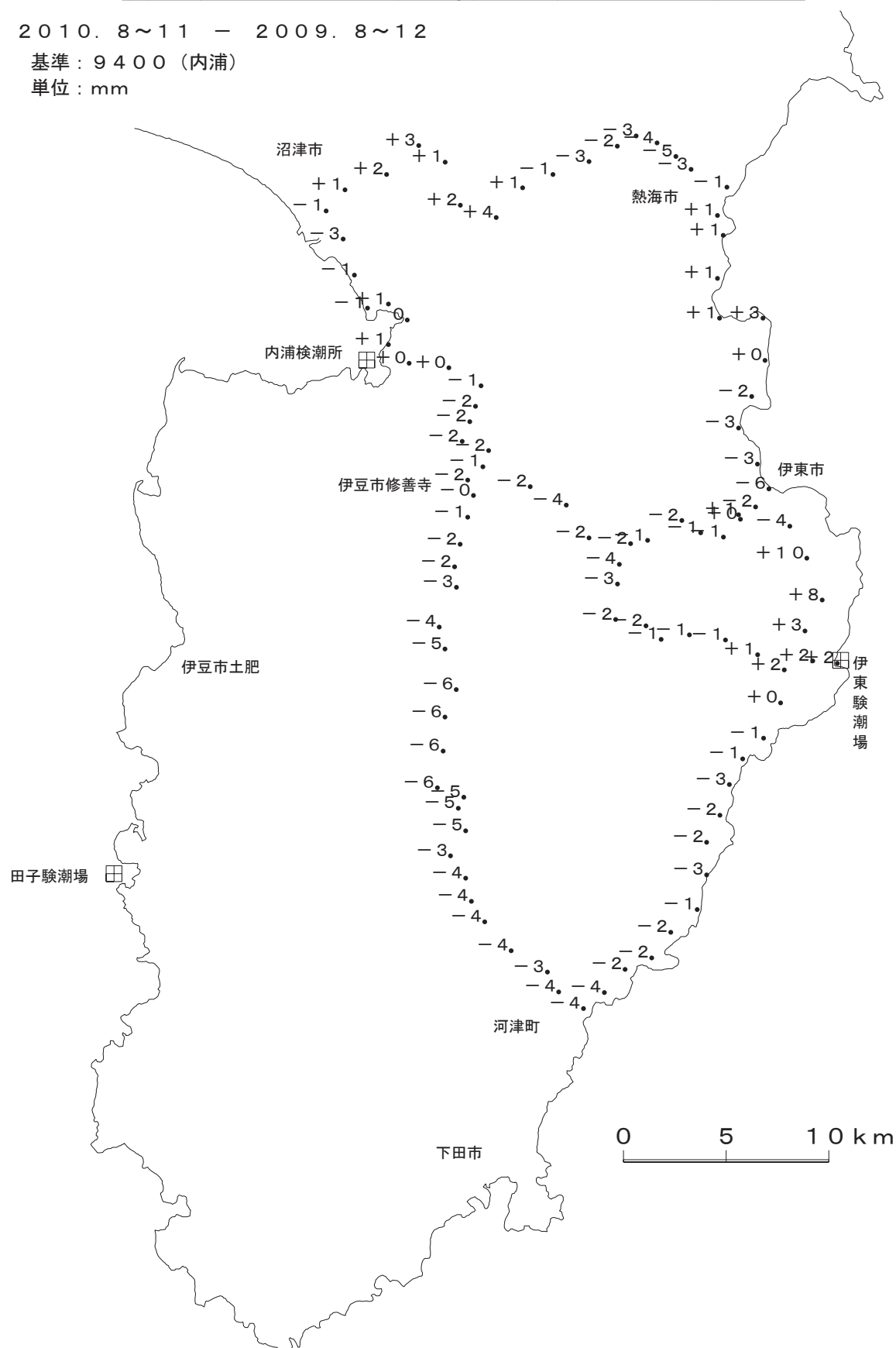
第9図 水準測量による伊豆半島の上下変動
