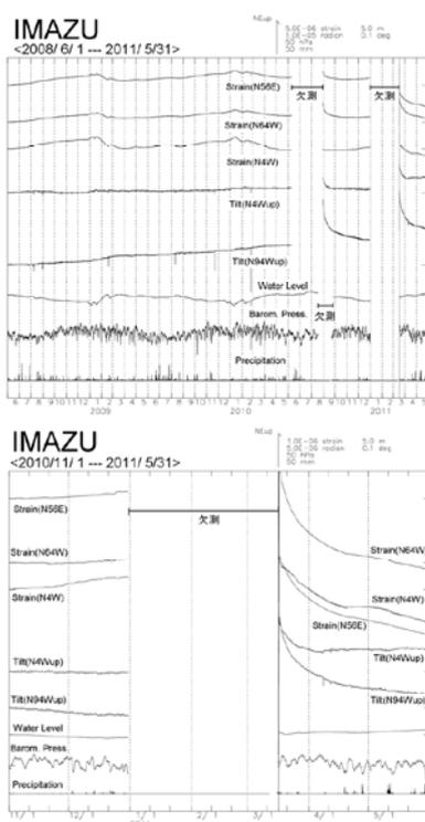
第2図 今津観測点における(上)2008年6月~2011年5月,(下)2010年11月~2011年5月のひずみ・傾斜変化(時間値)。毎年1月下旬から3月のひずみ・水位変化は、観測点付近の融雪のための地下水汲み上げに伴うもの。2010年6月から8月、2010年末から2011年3月中旬までの欠測は電源トラブルによるもの。
