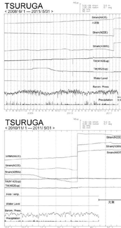
第3図 敦賀観測点における(上)2008年6月~2011年5月,(下)2010年11月~2011年5月のひずみ・傾斜変化(時間値)。2008年12月、2009年3月、4月、11月、2010年6月、7月、8月のひずみ変化は温度計故障のため。傾斜N52Eup成分に2009年7月頃から見られる変化の原因は不明。ひずみN38W成分の2010年1月の縮み変化は毎年冬に見られるものだが、変化の原因は不明。
