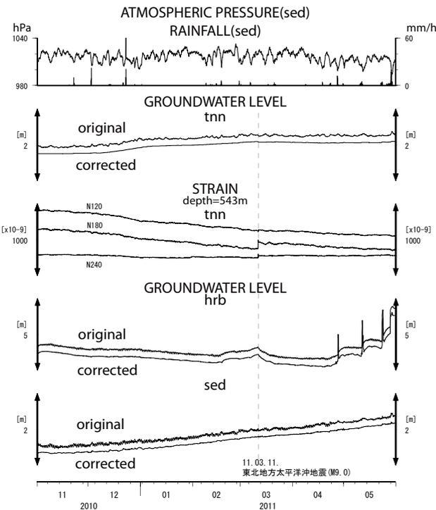
第4図 tnn・hrb・sedの地下水位とtnnの地殻歪の2010年11月～2011年5月の観測結果。
