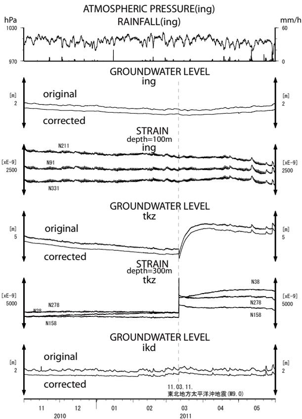
第3図 ing・tkz・ikdの地下水位とing・tkzの地殻歪の2010年11月～2011年5月の観測結果。
