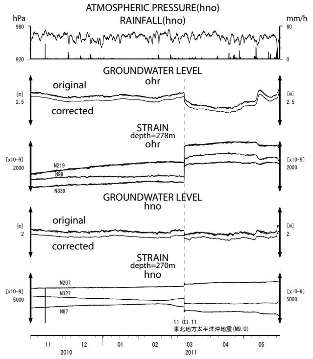
第5図 ohr・hnoの地下水位・地殻歪の2010年11月～2011年5月の観測結果。
