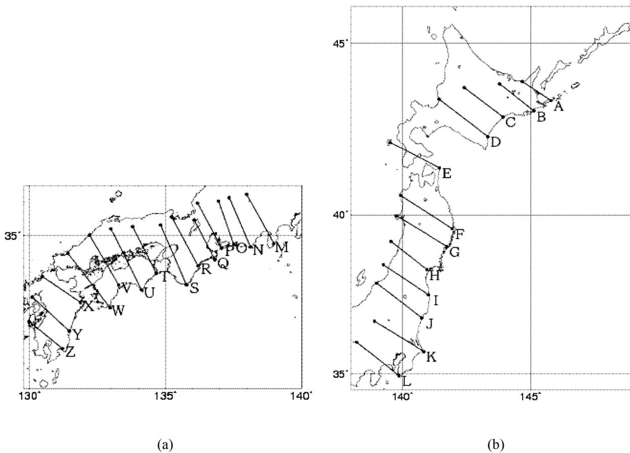
第1図 海溝と直交する方向の全国のGNSS基線.
