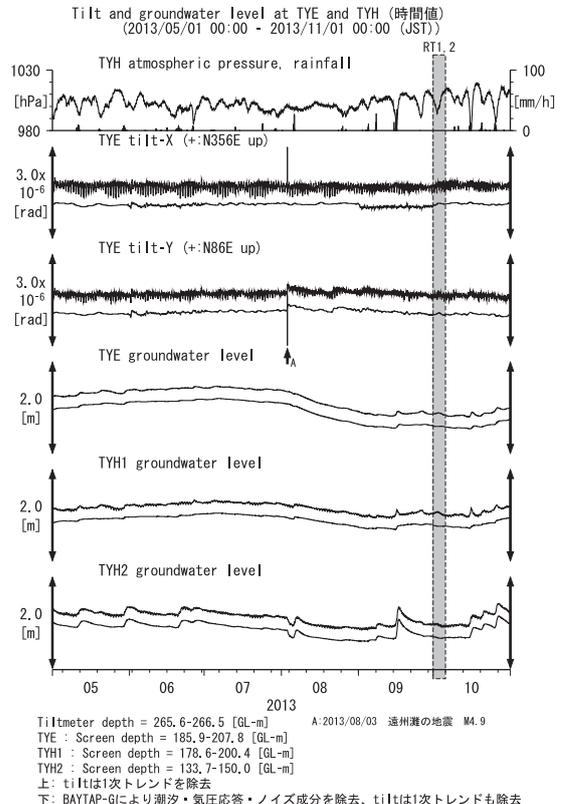
第5図 TYEおよびTYHにおける傾斜・地下水位観測結果 (2013年5月～2013年10月)
