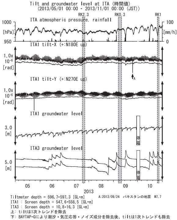
第10図 ITAにおける傾斜・地下水位観測結果 (2013年5月～2013年10月)
