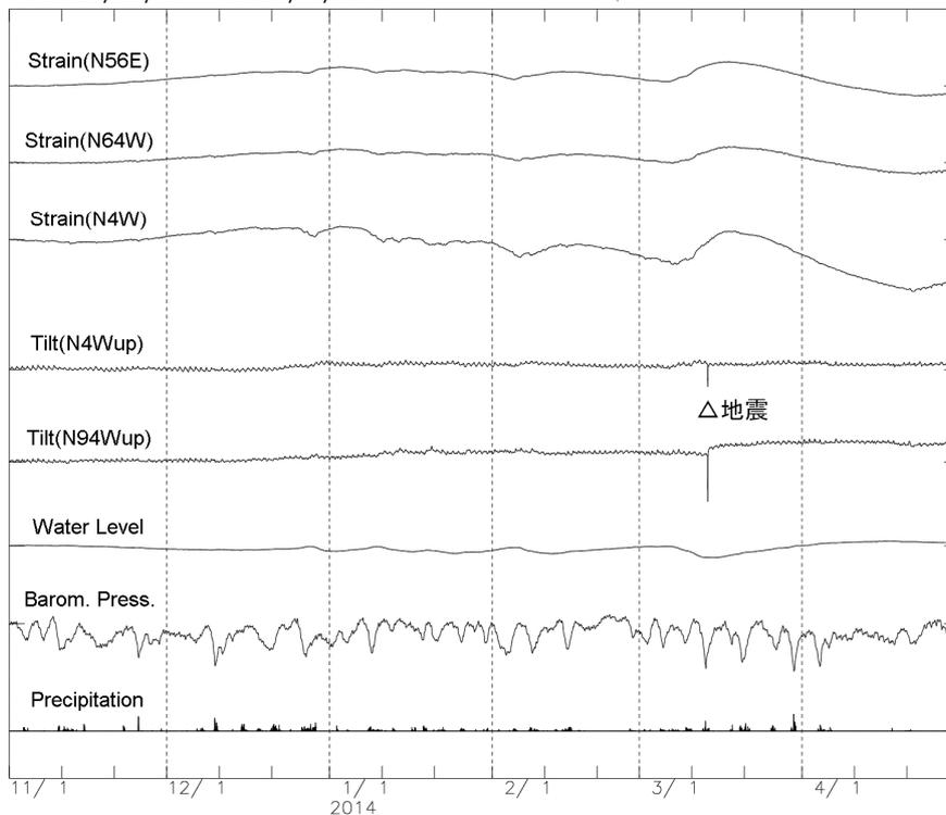
第2図 今津観測点における(上)2011年5月~2014年4月, (下)2013年11月~2014年4月のひずみ・傾斜変化(時間値)。毎年冬のひずみ・水位変化は、観測点付近の融雪のための地下水汲み上げに伴うもの。2011年8月中旬から10月下旬までの環境要素の欠測は収録装置の障害によるもの。
