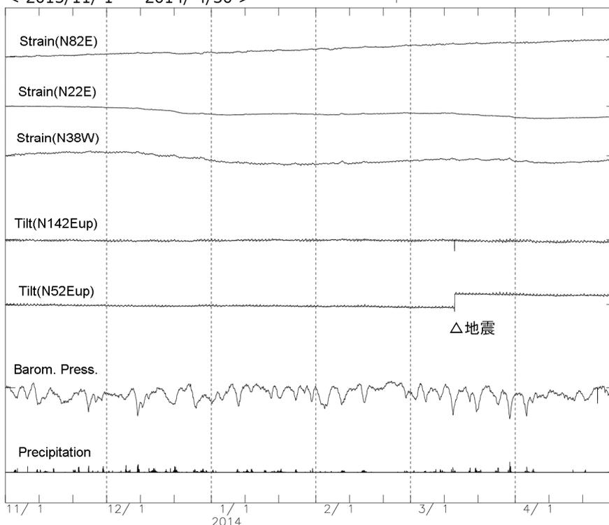
第3図 敦賀観測点における(上)2011年5月~2014年4月、(下)2013年11月~2014年4月のひずみ・傾斜変化(時間値)。2013年8月の欠測は電源断によるもの。
