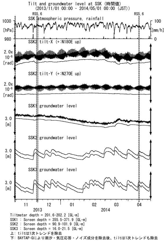
第30図 SSKにおける傾斜・地下水位観測結果 (2013年11月～2014年4月)
