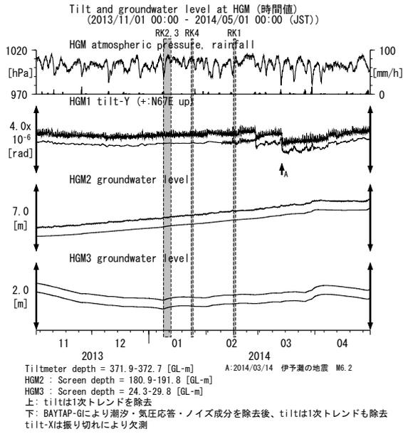
第18図 HGM における傾斜・地下水位観測結果(2013年11月～2014年4月)
