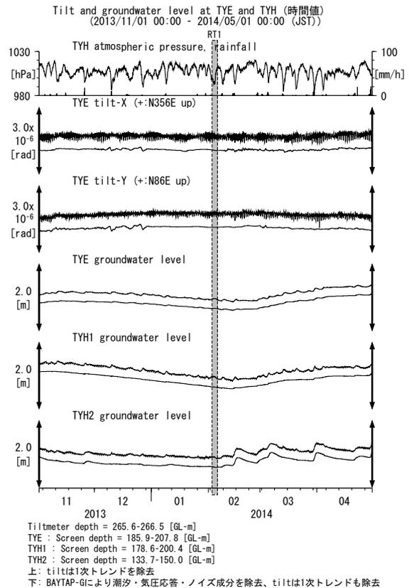
第7図 TYEおよびTYHにおける傾斜・地下水位観測結果(2013年11月~2014年4月)
