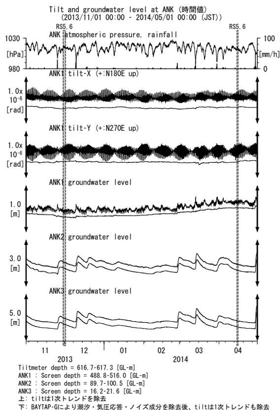
第24図 ANKにおける傾斜・地下水位観測結果(2013年11月～2014年4月)
