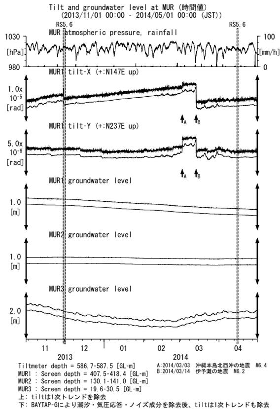
第26図 MURにおける傾斜・地下水位観測結果(2013年11月~2014年4月)
