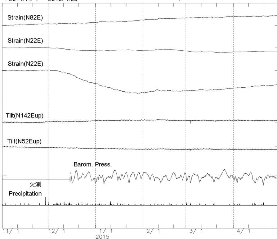
第3図 敦賀観測点における(上)2012年5月～2015年4月, (下)2014年11月～2015年4月のひずみ・傾斜変化(時間値)。
