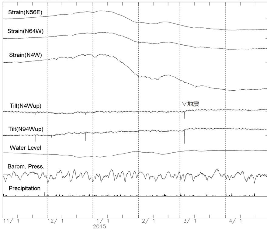
第2図 今津観測点における(上)2012年5月～2015年4月、(下)2014年11月～2015年4月のひずみ・傾斜変化(時間値)。毎年冬のひずみ・水位変化は、観測点付近の融雪のための地下水汲み上げに伴うもの。
