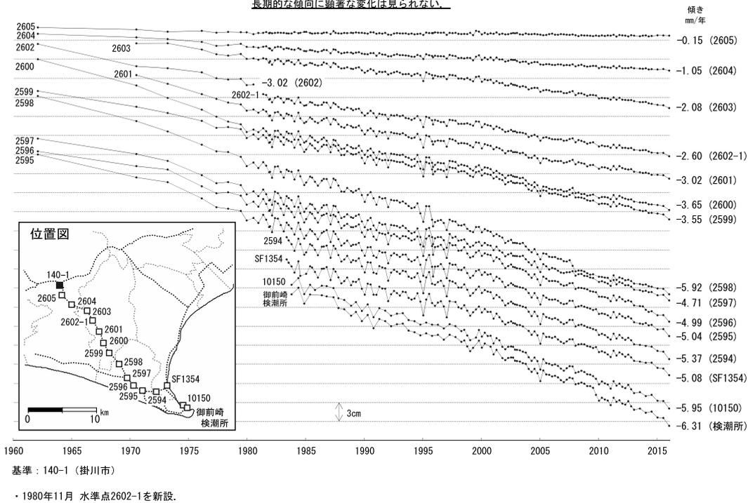
第5図 水準点 140-1 (掛川市) を基準とした掛川～御前崎間の各水準点の高さの経年変化
