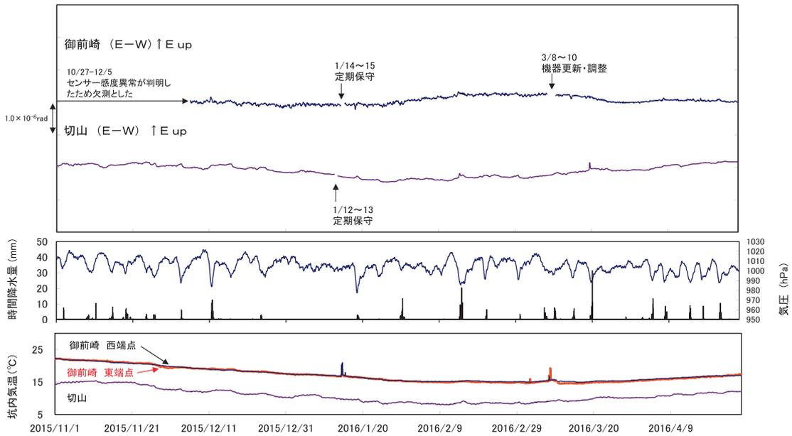
第 25 図 御前崎長距離水管傾斜計及び切山長距離水管傾斜計による傾斜観測結果
