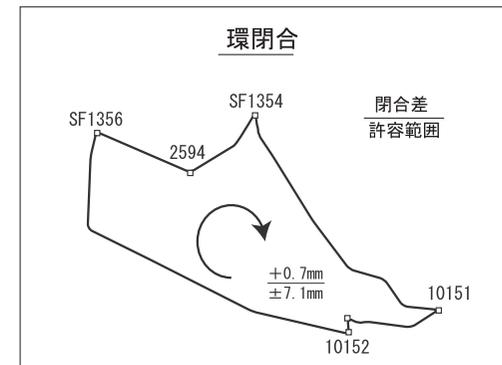
第 11 図 水準測量による御前崎先端部の上下変動（1）
