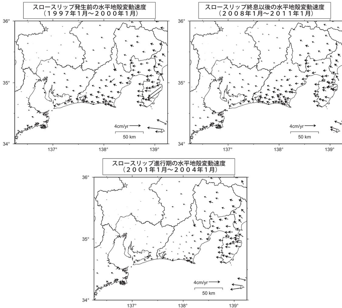
第 29 図 GNSS 観測による東海地方の最近 1 年間の水平変動及びスロースリップ開始前・進行期・終息後の水平変動速度 (白鳥固定)
