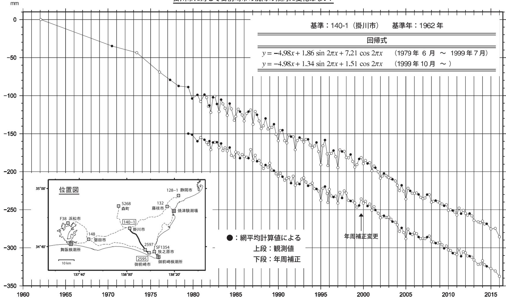
第2図 水準点 140-1（掛川市）を基準とした 2595（御前崎市浜岡）の高さの経年変化
