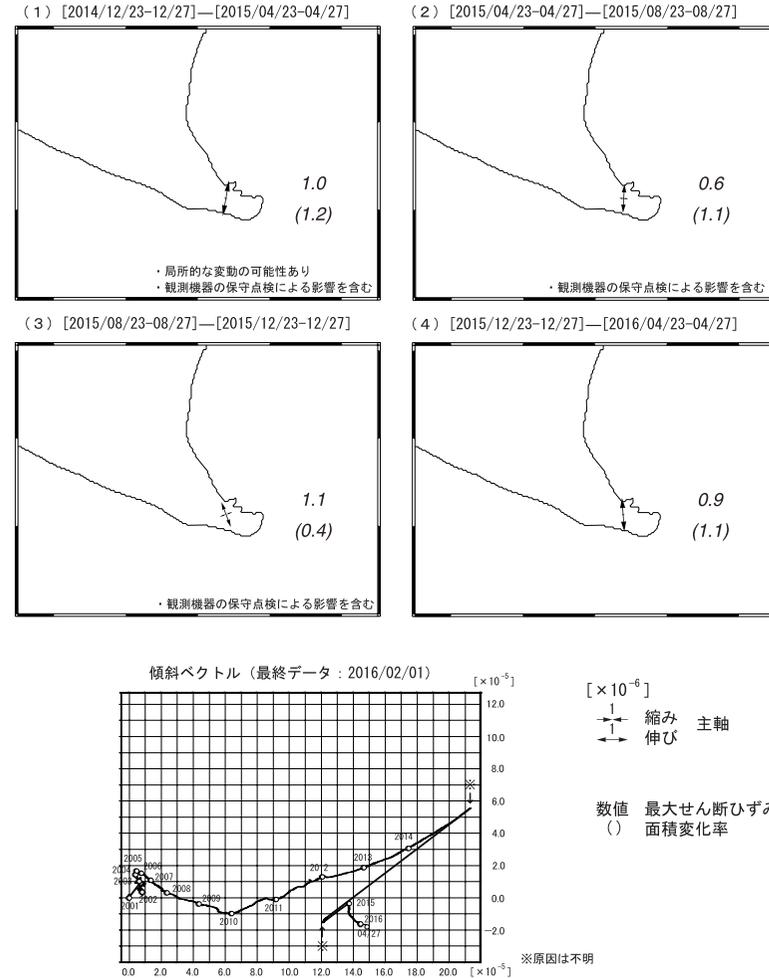
第 28 図 御前崎地中地殻活動監視装置による連続観測結果 (水平歪および傾斜ベクトル)
