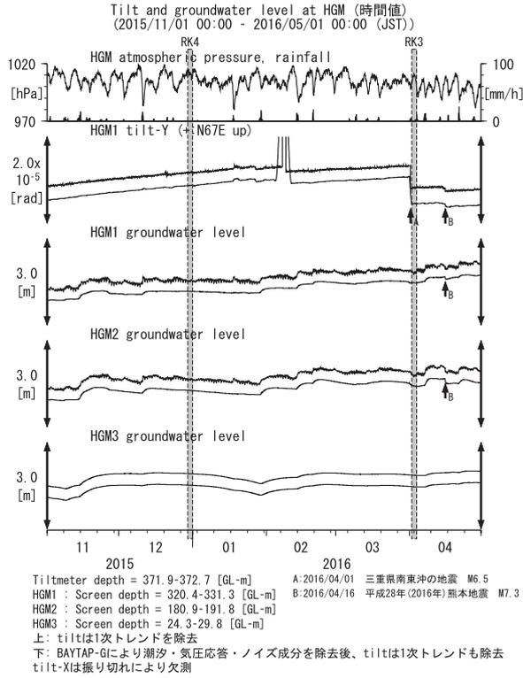
第 18 図 HGM における傾斜・地下水位観測結果 (2015 年 11 月～2016 年 4 月)
