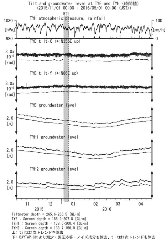
第7図 TYEおよびTYHにおける傾斜・地下水位観測結果 (2015年11月～2016年4月)
