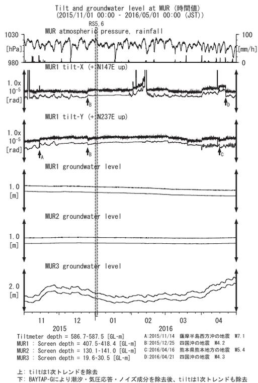
第26図 MURにおける傾斜・地下水位観測結果 (2015年11月～2016年4月)
