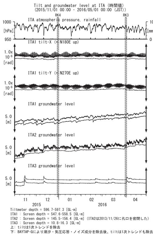
第12図 ITAにおける傾斜・地下水位観測結果 (2015年11月～2016年4月)
