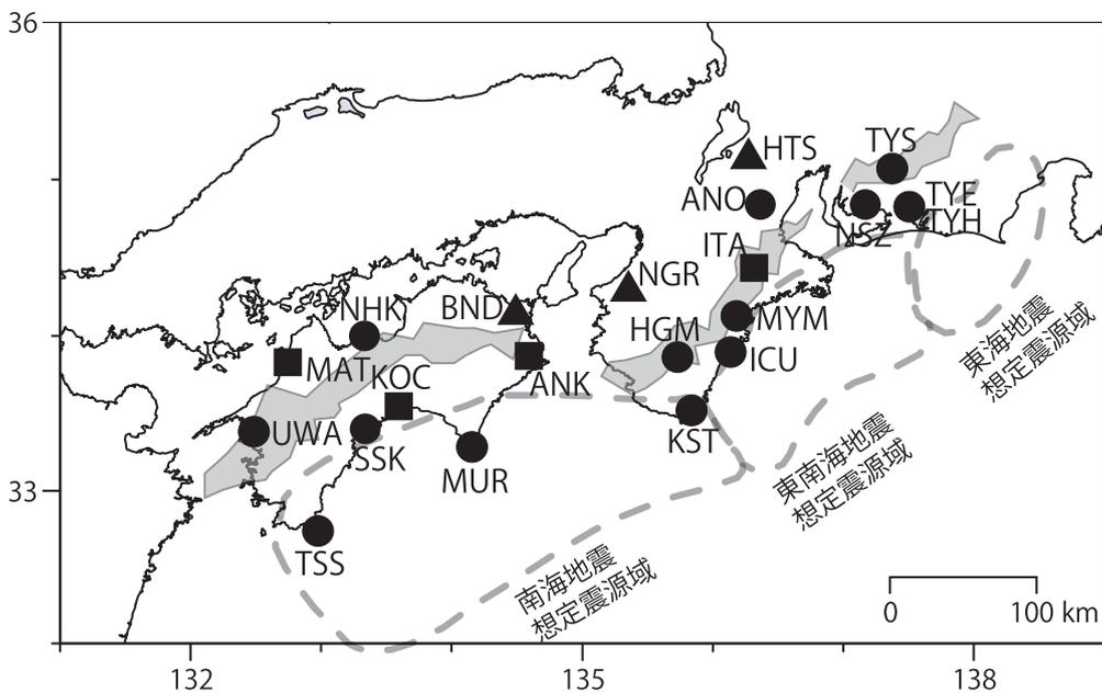
第1図 地下水等総合観測点の分布図 (●, ■, ▲). 観測点の一覧は第1表に示す. ●はデジタル方式の石井式歪計・傾斜計を併設している新規観測点, ■は Gladwin 式歪計・ミットヨ式傾斜計を併設している新規観測点, ▲はアナログ方式の石井式歪計を併設している既存の観測点. 灰色の領域は短期的 SSE 及び深部低周波微動が定期的に発生していると考えられる地域.
