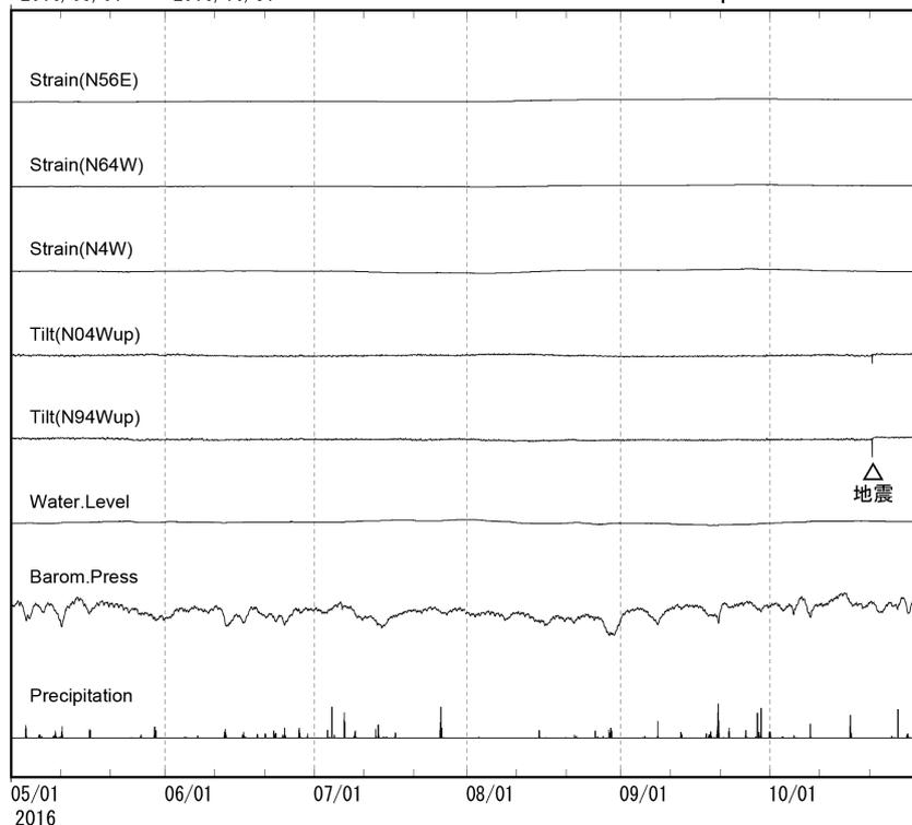
第2図 今津観測点における(上) 2013年11月~2016年10月, (下) 2016年5月~10月のひずみ・傾斜変化(時間値). 毎年冬のひずみ・水位変化は, 観測点付近の融雪のための地下水汲み上げに伴うもの.
