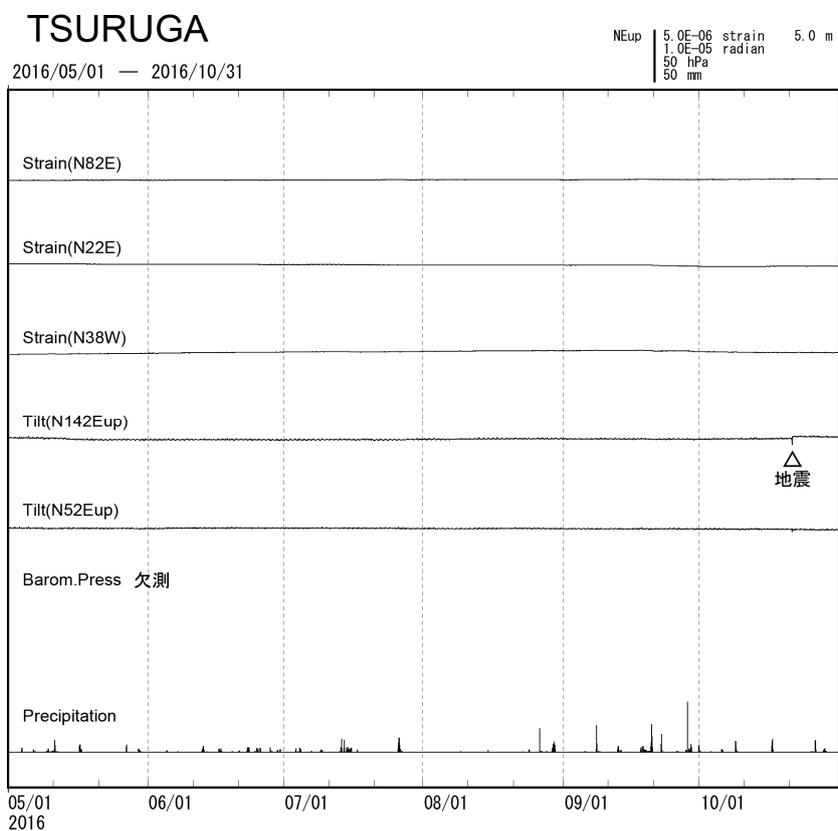
第 3 図 敦賀観測点における(上) 2013 年 11 月～2016 年 10 月, (下) 2016 年 5 月～10 月のひずみ・傾斜変化 (時間値).
