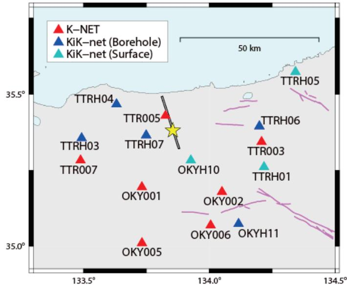
第 1 図 解析に用いた観測点の分布および断層面の地表投影. 星印は破壊開始点を示す.
