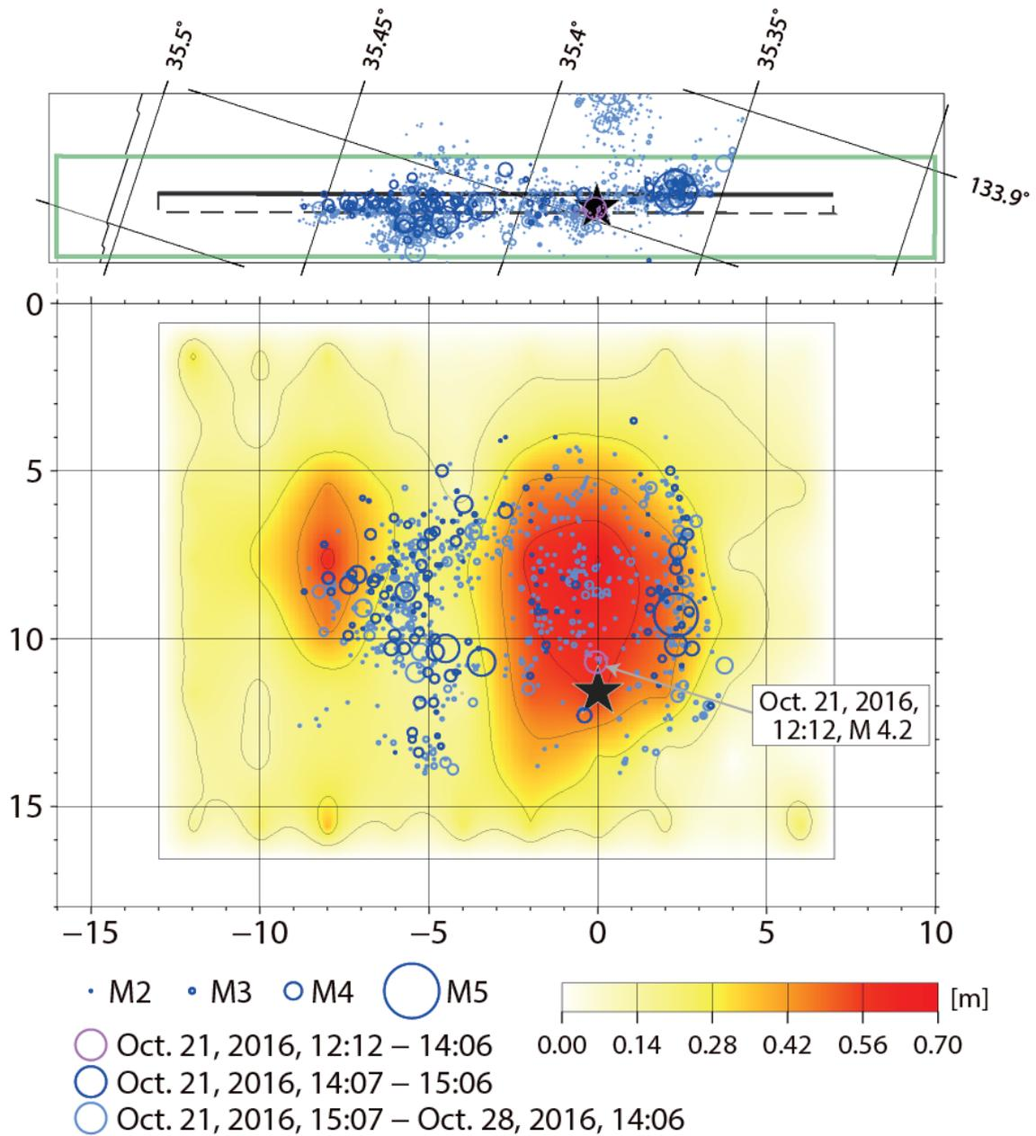
第5図 前震および余震の空間分布と最終すべり分布の比較。震源情報にはHi-net震源カタログを用いた。下図は上図の緑枠内の領域に対応する断面図である。
