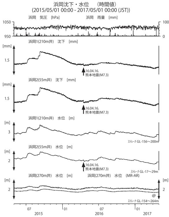
第 21 図 浜岡における沈下等の観測結果 (2015 年 5 月～2017 年 4 月)
