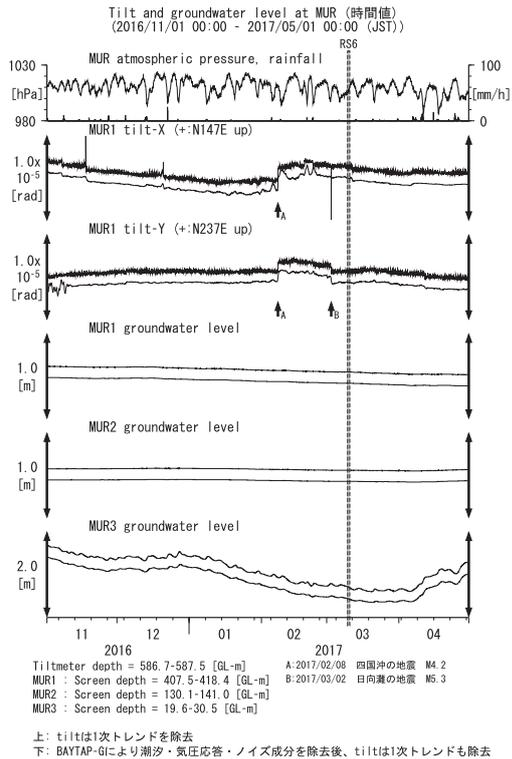
第26図 MURにおける傾斜・地下水位観測結果 (2016年11月～2017年4月)
