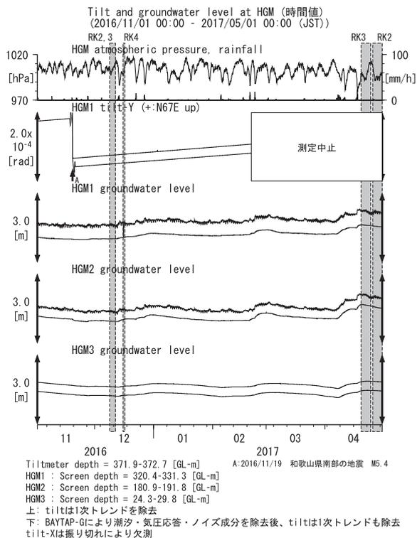
第 18 図 HGM における傾斜・地下水位観測結果 (2016 年 11 月～2017 年 4 月)
