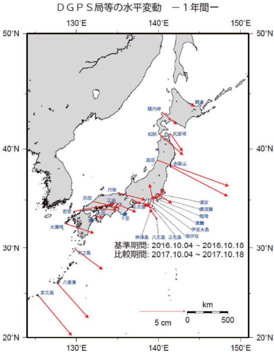
第 5 図 DGPS 局等の GPS 連続観測から求めた水平変動（固定局：下里）
