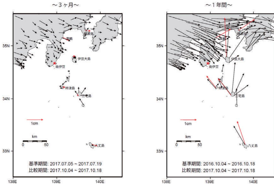
第1図 伊豆諸島海域 GPS 測点および水平変動ベクトル図 (★固定局：南伊豆)
