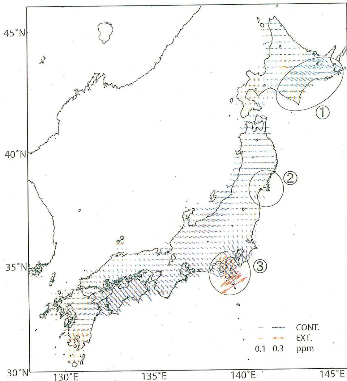
GPS座標値データに基づいて1年間の歪み変化図を作成した。座標値の15日分の平均値から1年間の変位ベクトルを算出し、それに基づいて歪みを計算している。上図期間においては、以下のような特徴が見られる。
