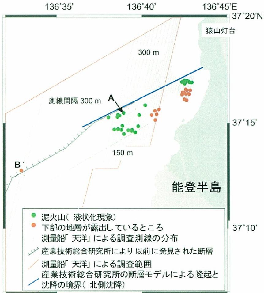
図 3. サイドスキャンソナーで得られた音響画像から推定された泥火山や地下の地層(岩盤)露出の分布 (暫定).
