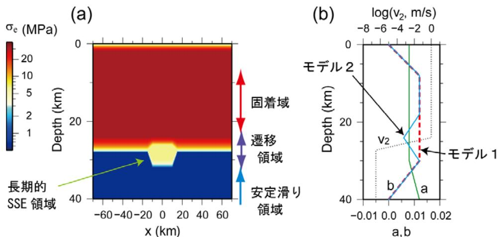
図1. (a)仮定した有効法線応力の分布.(b)緑実線, 赤破線はそれぞれ, 仮定したすべり速度・状態依存摩擦則の摩擦パラメータ  $b$  の深さ分布 (モデル1). 青実線は, モデル2において仮定の分布. 黒点線はカットオフ速度
