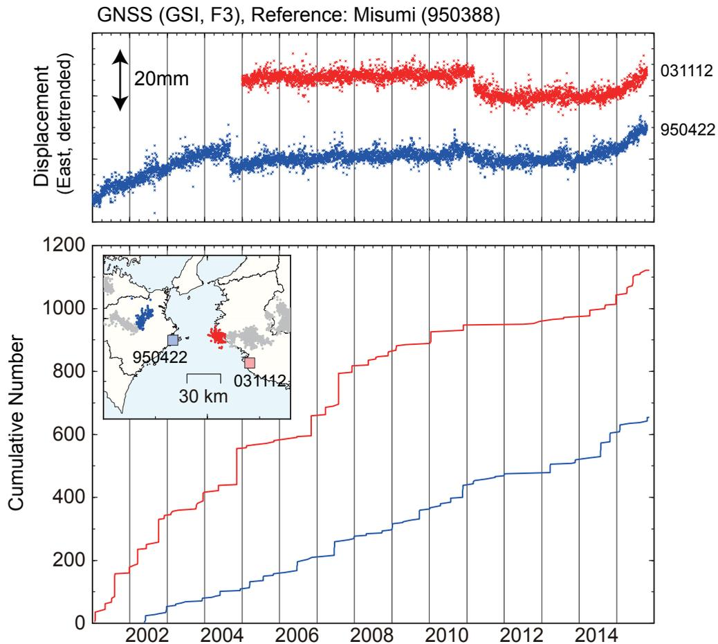
図3. (上図) GNSS データ (国土地理院 GEONET F3 解) による, 三隅を基準点としてトレンドおよびアンテナ交換によるオフセットを除去した, 2015 年 10 月 24 日までの白浜 (赤×印), 阿南 2 (青×印) の東方向の変位 (上が東方向). 白浜および阿南 2 の各 GEONET 点の位置は, 下図内の地図にそれぞれ赤四角, 青四角で示した.
