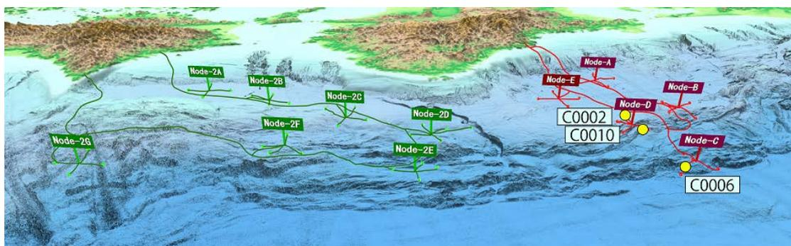
南海トラフ 東南海・南海地震震源域に展開された DONET (地震・津波観測監視システム) と長期孔内観測システム(C0002, C0010) の位置(黄丸). C0006 には 2017 年に長期孔内観測システムの設置を予定している。
