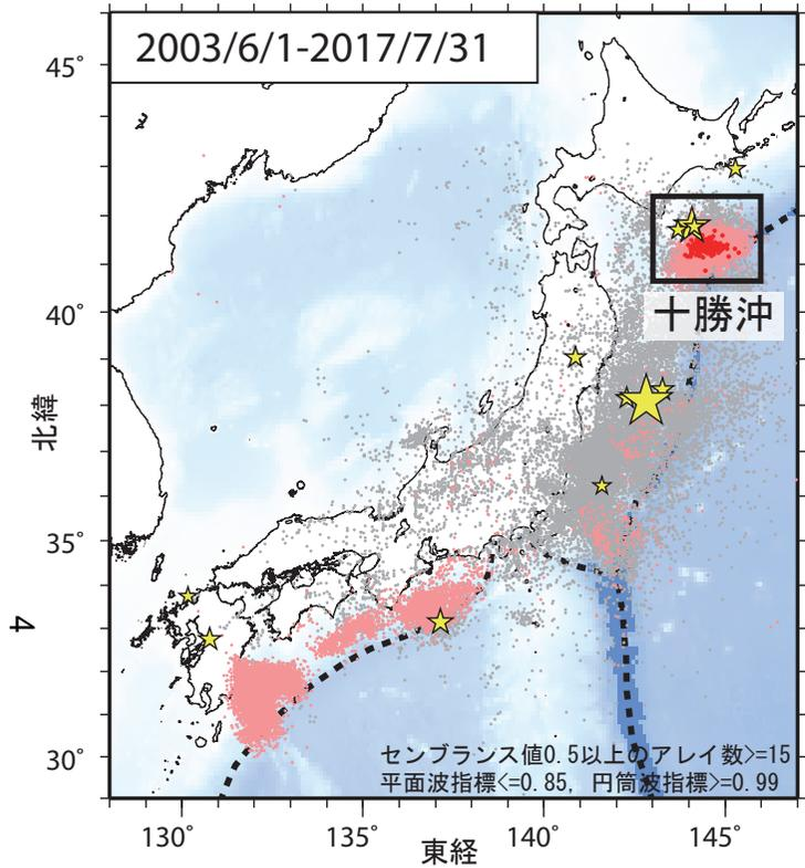
第1図. 2003年6月1日から2017年7月31日までの期間にアレイ解析によって検出されたイベントの震央分布. 検出イベントを防災科研 Hi-net の手動または自動検測震源と照合し, 対応する地震が見出されたイベントを灰色で, それ以外を桃色 (2016年4月30日以前), および赤色 (5月1日以降) の点でそれぞれ示す. これらは主として周期10秒以上に卓越する超低周波地震を表すが, 東北地方太平洋沖地震の発生以降は, 除去しきれない通常の地震を含む. 期間内に発生した  $M7$  以上の地震 (ただし, 2011年～2015年の期間は東北地方太平洋沖地震の本震のみ) の震央を黄色星印で示す.
