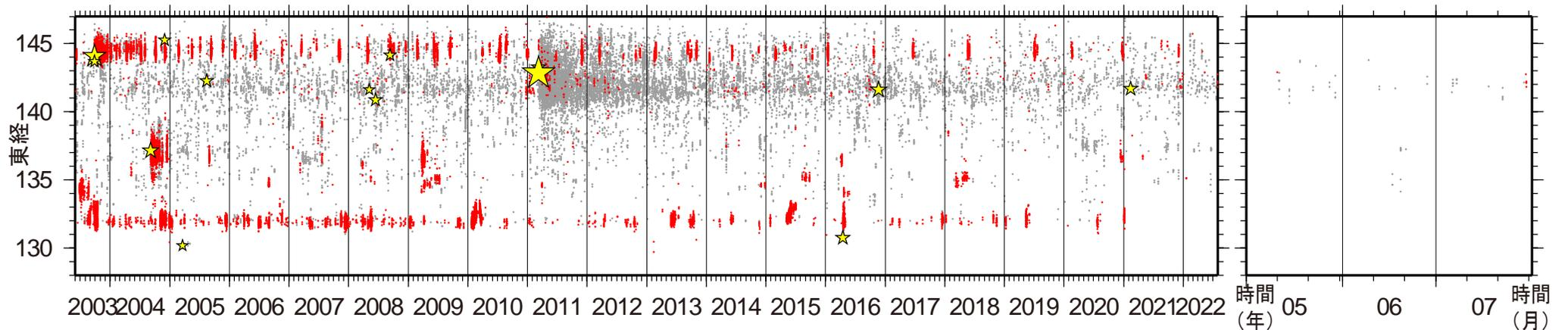
第2図. 2003年6月1日から2022年7月31日までの期間 (左) および直近約3か月間 (右) に検出されたイベントの時空間分布. 検出されたイベントを防災科研 Hi-net 手動または自動検測震源と照合し, 対応する地震が見出されたイベントを灰色で, それ以外を赤色の点でそれぞれ示す. その他は第1図に同じ.
