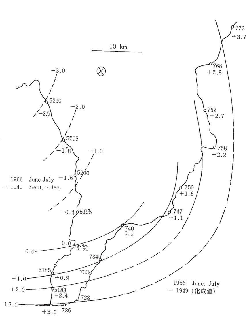
第3図 岐阜県中部地震後の変動図
