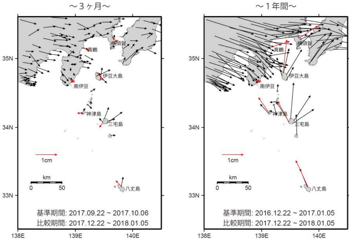
第 1 図 伊豆諸島海域 GPS 測点および水平変動ベクトル図（固定点：南伊豆）
