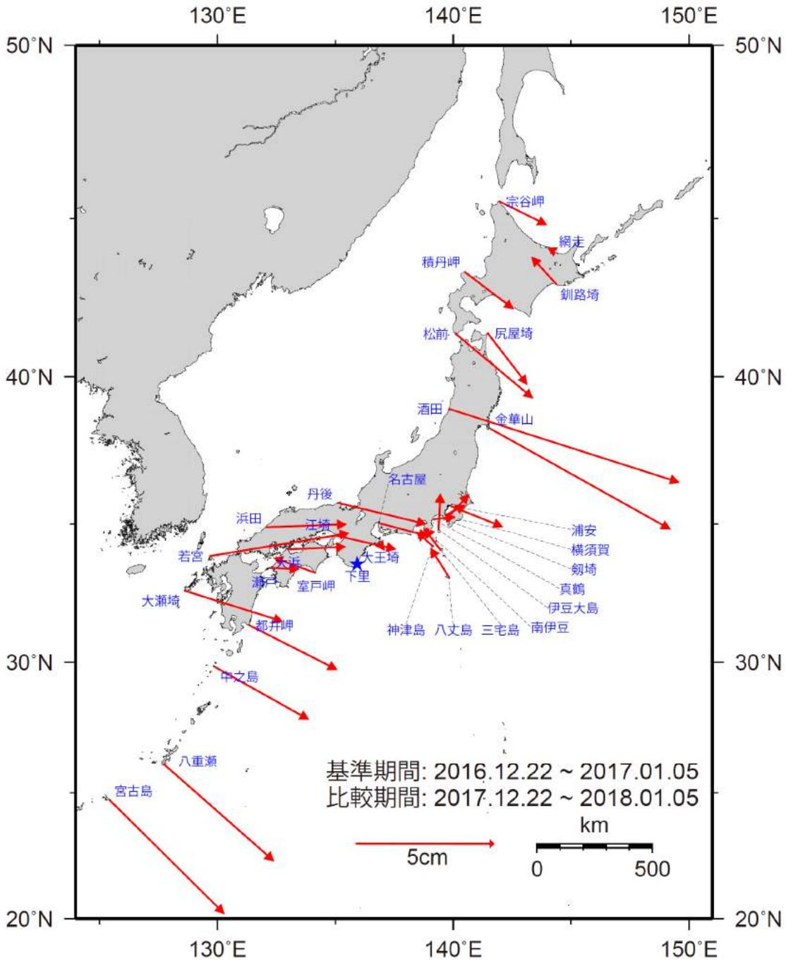
第3図 DGPS局等のGPS連続観測から求めた水平変動(固定局:下里)
