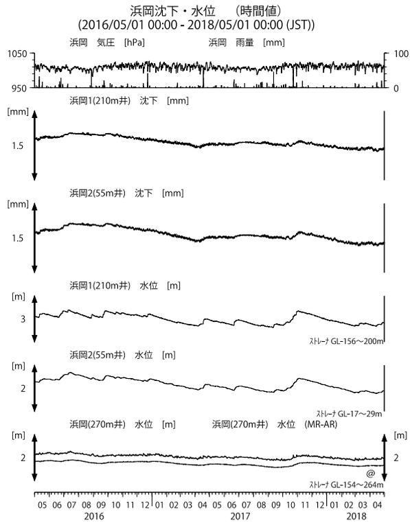
第21図 浜岡における沈下等の観測結果(2016年5月～2018年4月)
