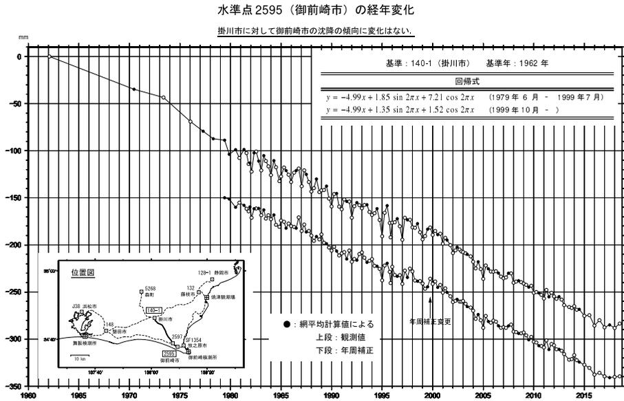
第 7 図 水準点 140-1（掛川市）を基準とした 2595（御前崎市浜岡）の高さの経年変化
