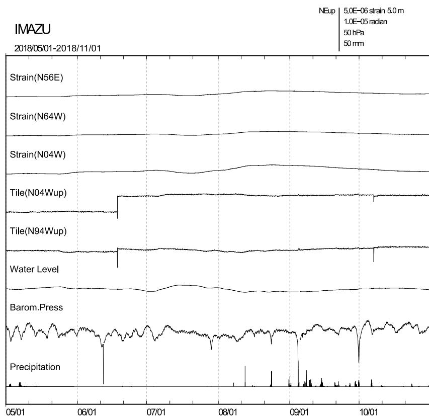
第2図 今津観測点における(上)2015年11月～2018年10月、(下)2018年5月～2018年10月のひずみ・傾斜変化(時間値)。毎年冬のひずみ・水位変化は、観測点付近の融雪のための地下水汲み上げに伴うもの。
