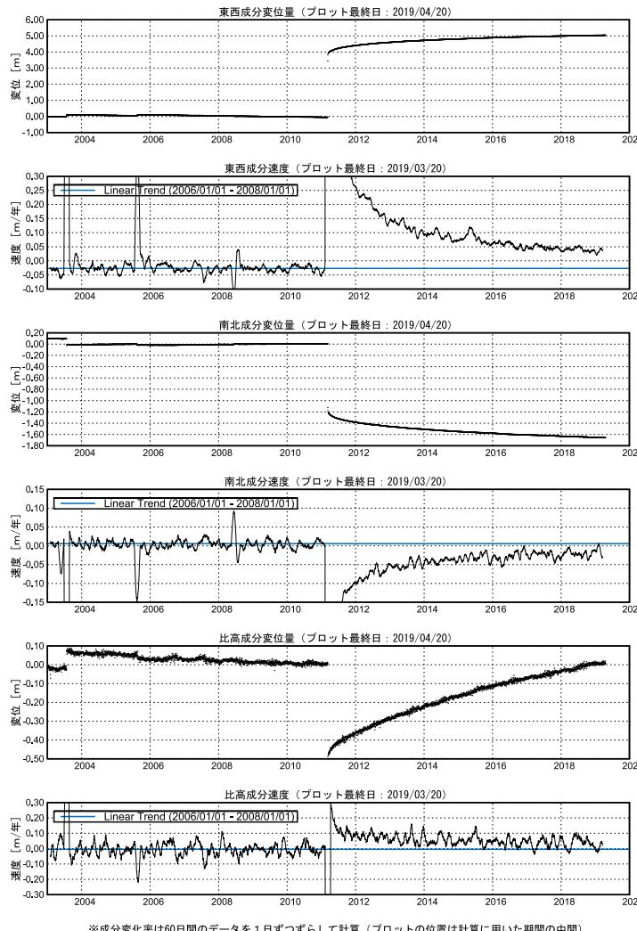
第14図 東北地方太平洋岸のGEONET観測点における地殻変動速度の変化
