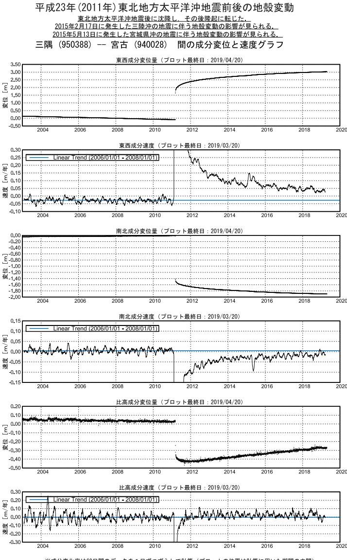
第12図 東北地方太平洋岸のGEONET観測点における地殻変動速度の変化
