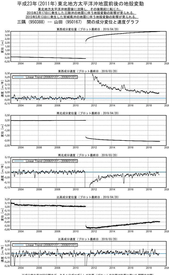
第13図 東北地方太平洋岸のGEONET観測点における地殻変動速度の変化
