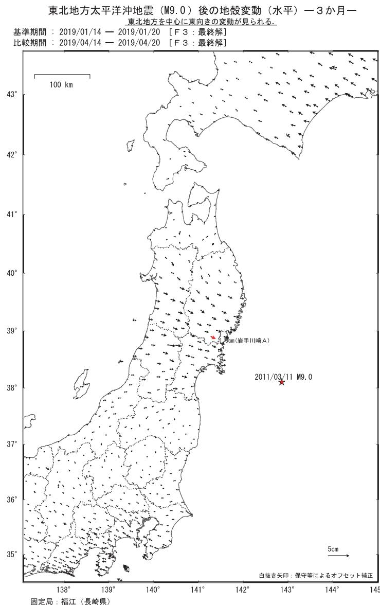
第4図 2011年東北地方太平洋沖地震後の地殻変動（最近3ヶ月、水平）
