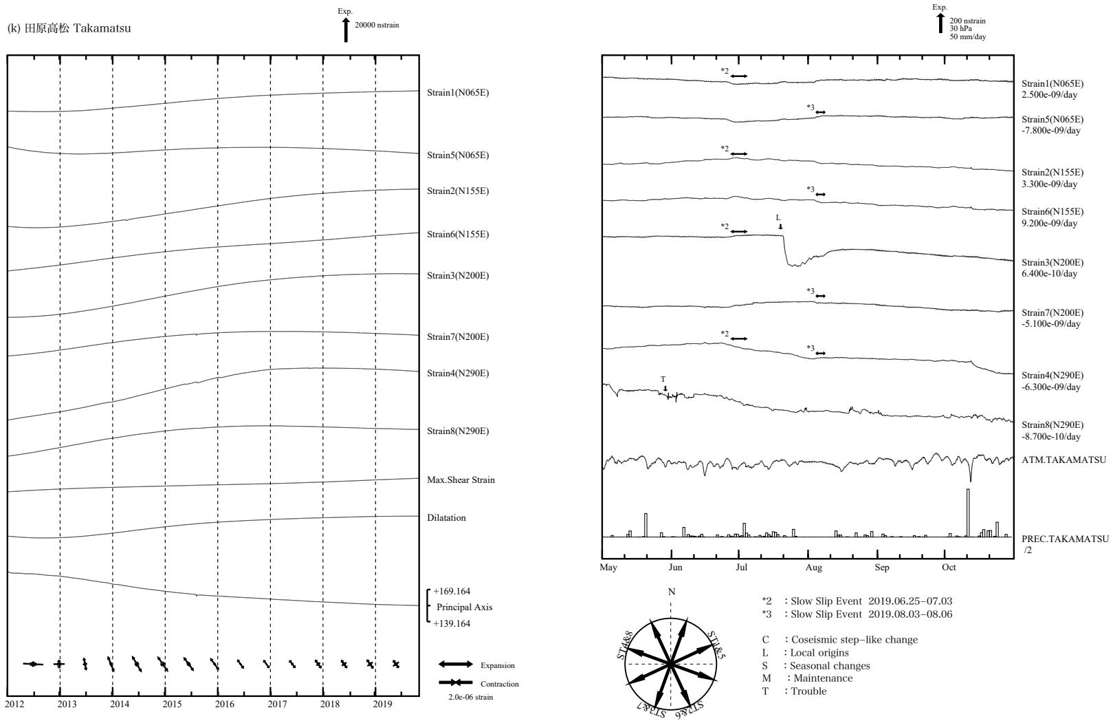
第4図(k) 左：2012年1月以後の多成分ひずみ計変化（日平均値）。主ひずみ・最大せん断ひずみ・面積ひずみは各方向成分から計算されている。右：2019年5月～10月の多成分ひずみ計変化（時間値：気圧・潮汐・地磁気補正した値）。各図下部に気圧変化と降水量を示す。
