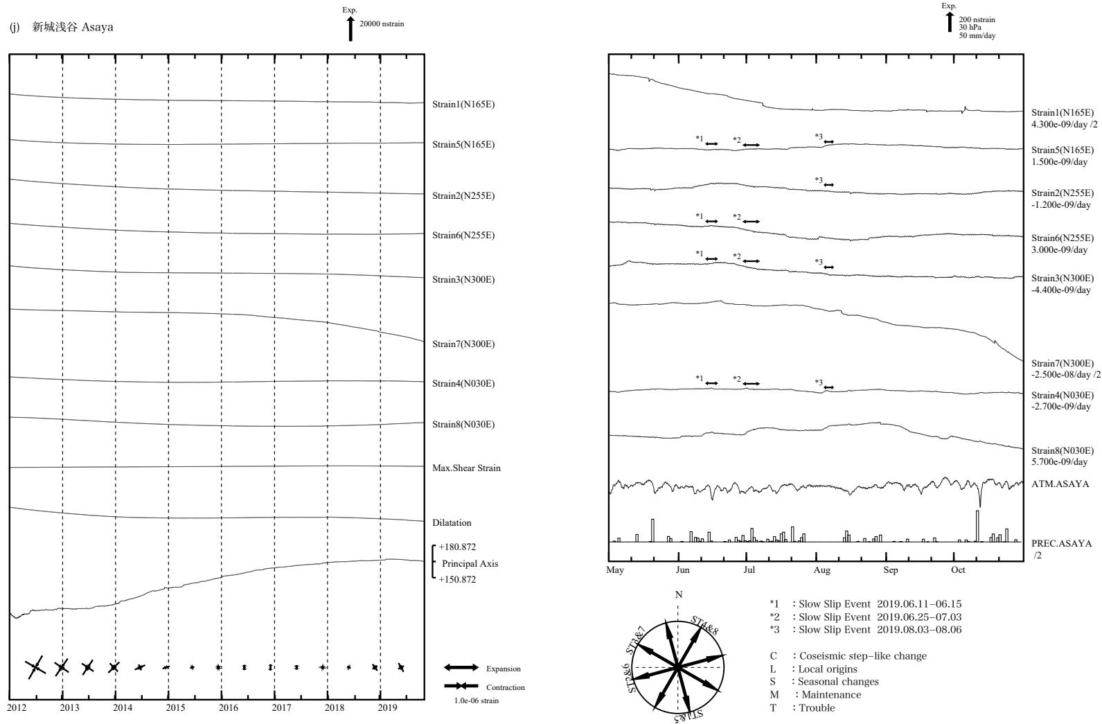
第4図(j) 左：2012年1月以後の多成分ひずみ計変化（日平均値）。主ひずみ・最大せん断ひずみ・面積ひずみは各方向成分から計算されている。右：2019年5月～10月の多成分ひずみ計変化（時間値：気圧・潮汐・地磁気補正した値）。各図下部に気圧変化と降水量を示す。
