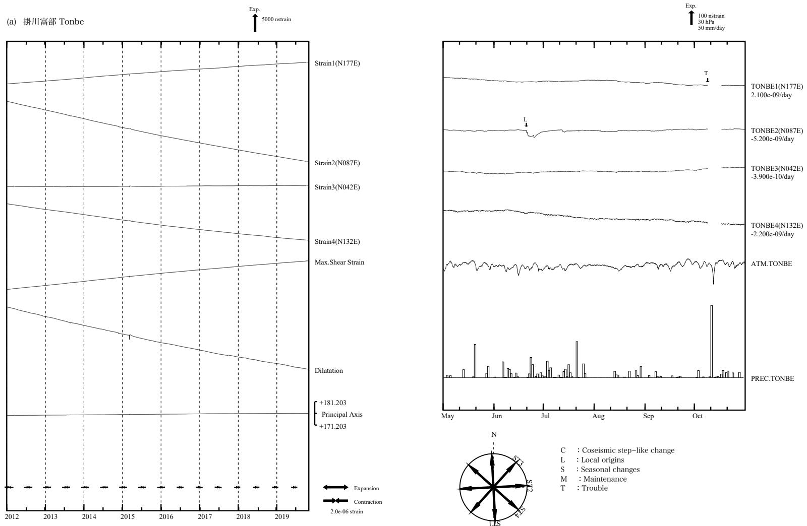
第4図(a) 左：2012年1月以後の多成分ひずみ計変化（日平均値）。主ひずみ・最大せん断ひずみ・面積ひずみは各方向成分から計算されている。
