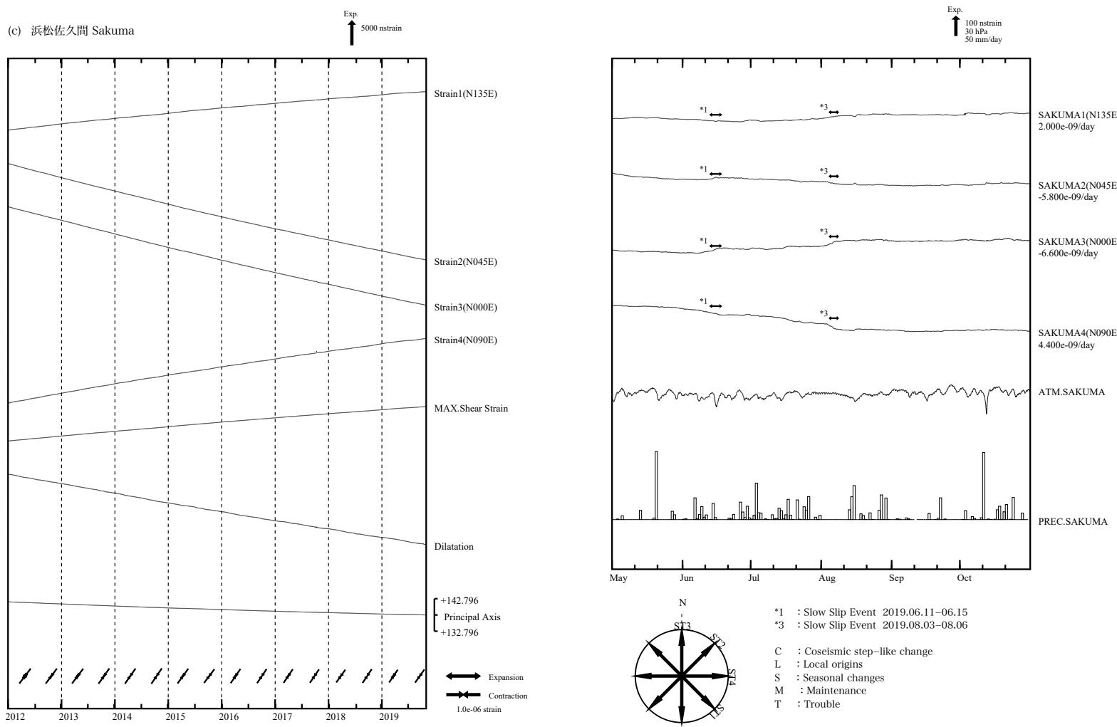
第4図(c) 左：2012年1月以後の多成分ひずみ計変化（日平均値）。主ひずみ・最大せん断ひずみ・面積ひずみは各方向成分から計算されている。
