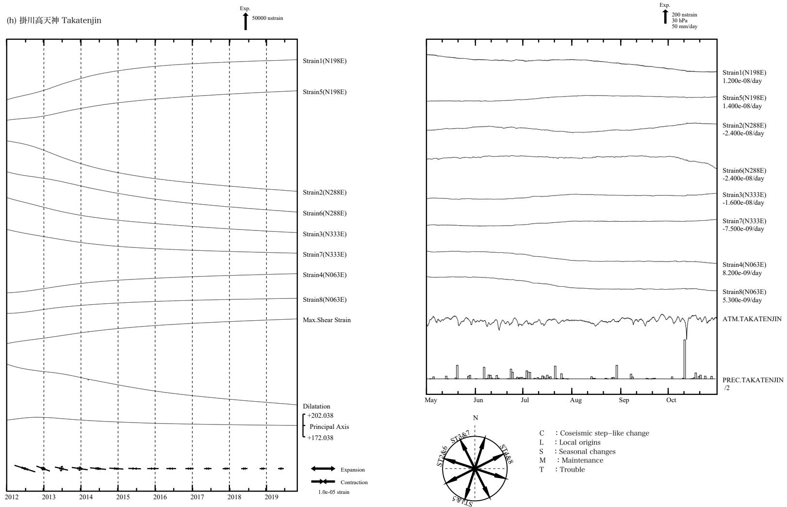
第4図(h) 左：2012年1月以後の多成分ひずみ計変化（日平均値）。主ひずみ・最大せん断ひずみ・面積ひずみは各方向成分から計算されている。右：2019年5月～10月の多成分ひずみ計変化（時間値：気圧・潮汐・地磁気補正した値）。各図下部に気圧変化と降水量を示す。
