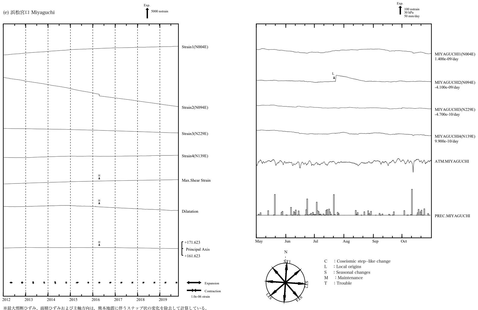
第4図(e) 左：2012年1月以後の多成分ひずみ計変化（日平均値）。主ひずみ・最大せん断ひずみ・面積ひずみは各方向成分から計算されている。
