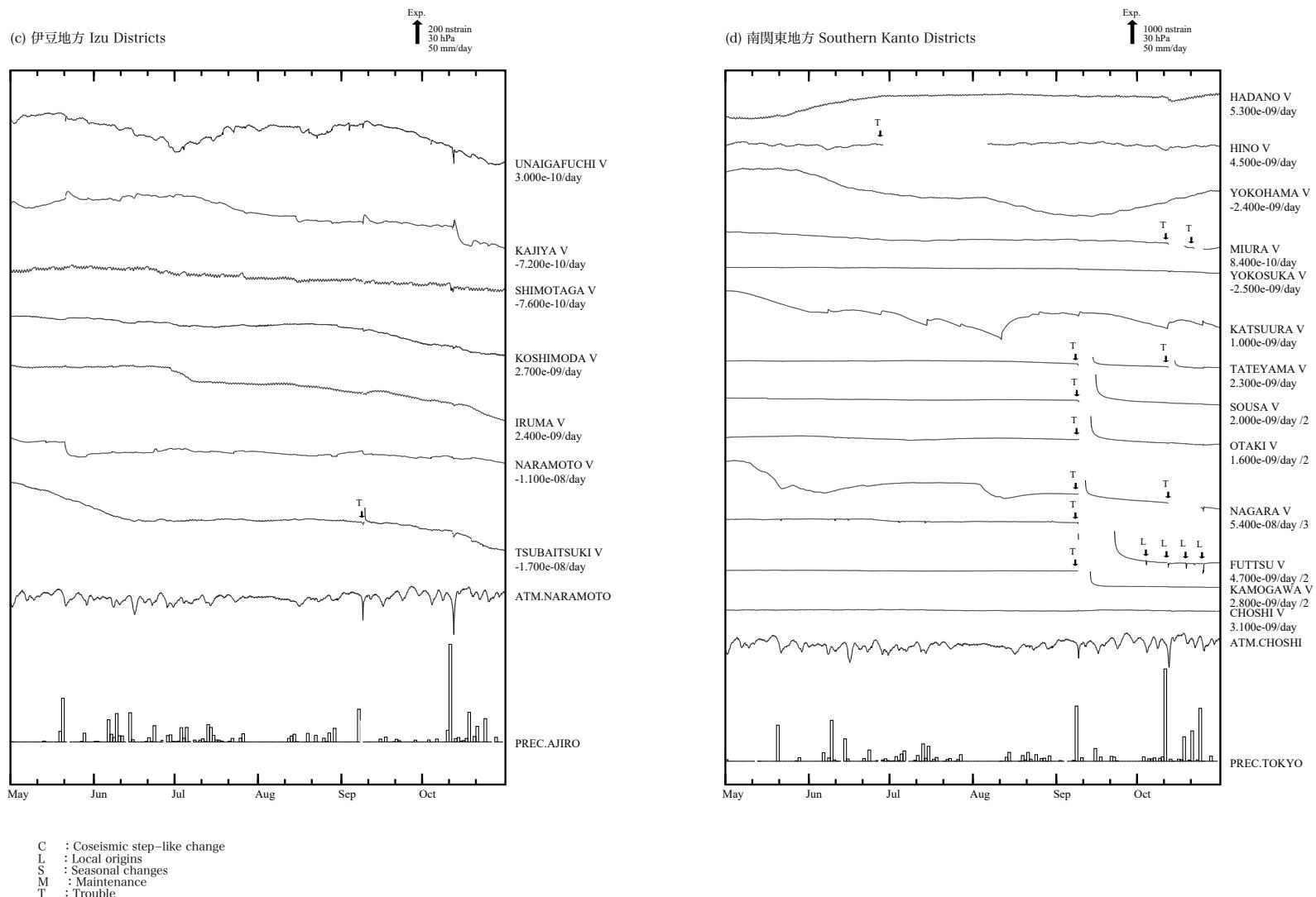
第3図(c), (d) 2019年5月～10月の東海・伊豆・南関東地域における区域別体積ひずみ（V）及び面積ひずみ（S）の変化（時間値：気圧・潮汐・降水補正した値）。各図下部に区域を代表する気圧変化と降水量を示す。地点名の下のD strain/day及び/Mはそれぞれ1日あたりのトレンド変化量をDとして補正していること及び縮尺を1/M倍にして表示していることを示している。
