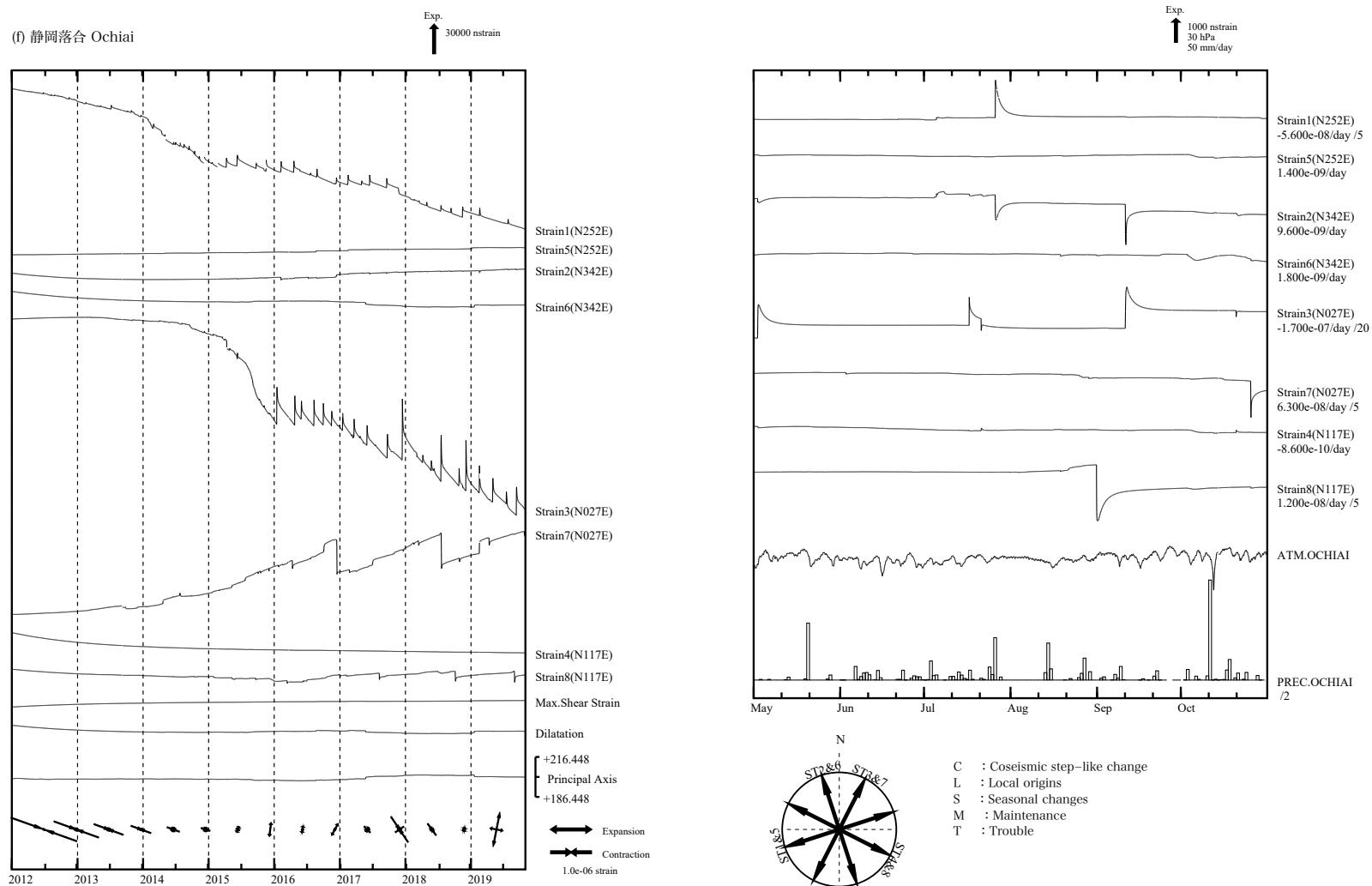
第4図(f) 左：2012年1月以後の多成分ひずみ計変化（日平均値）。主ひずみ・最大せん断ひずみ・面積ひずみは各方向成分から計算されている。右：2019年5月～10月の多成分ひずみ計変化（時間値：気圧・潮汐・地磁気補正した値）。各図下部に気圧変化と降水量を示す。
