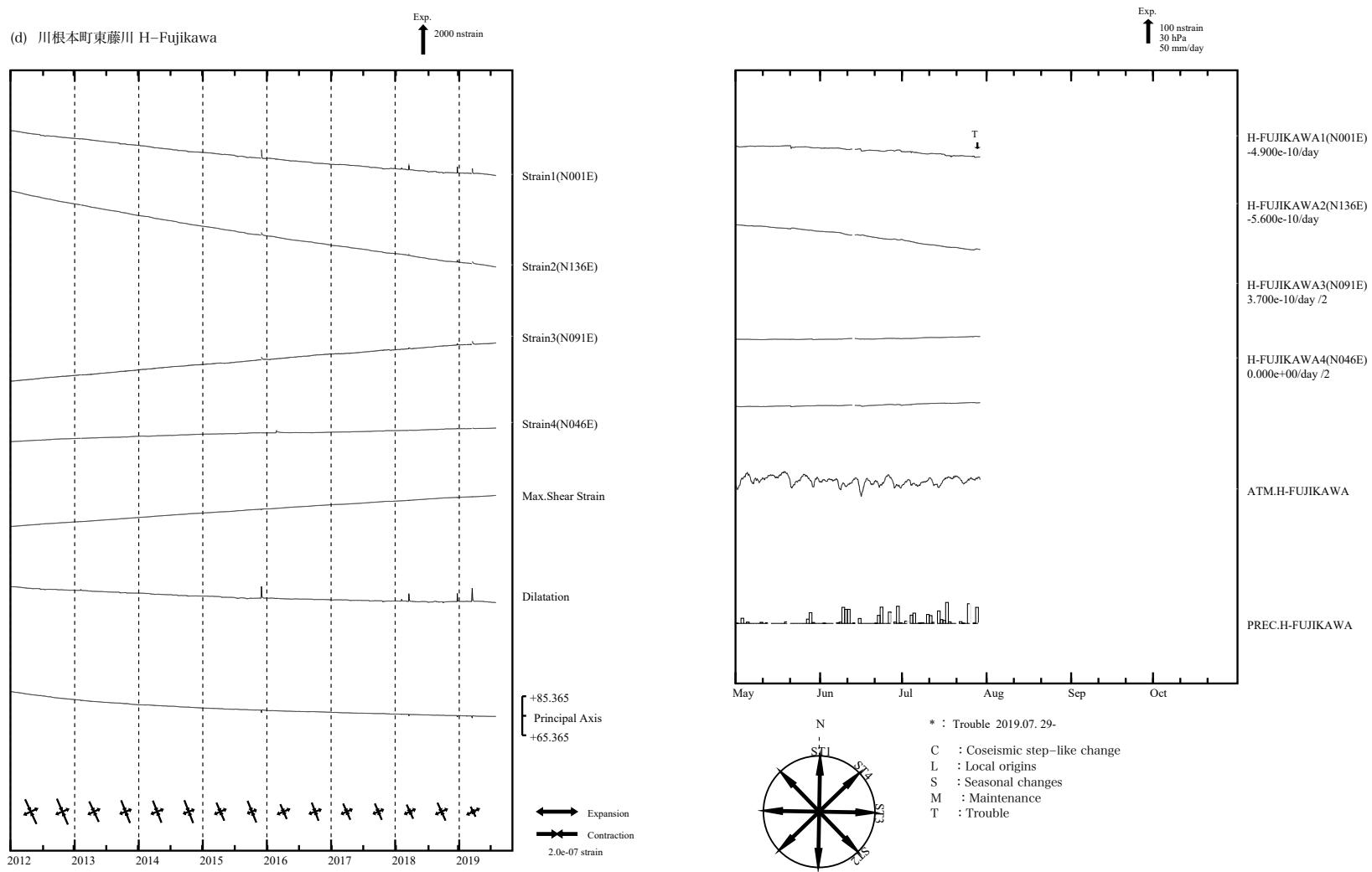
第4図(d) 左：2012年1月以後の多成分ひずみ計変化（日平均値）。主ひずみ・最大せん断ひずみ・面積ひずみは各方向成分から計算されている。
