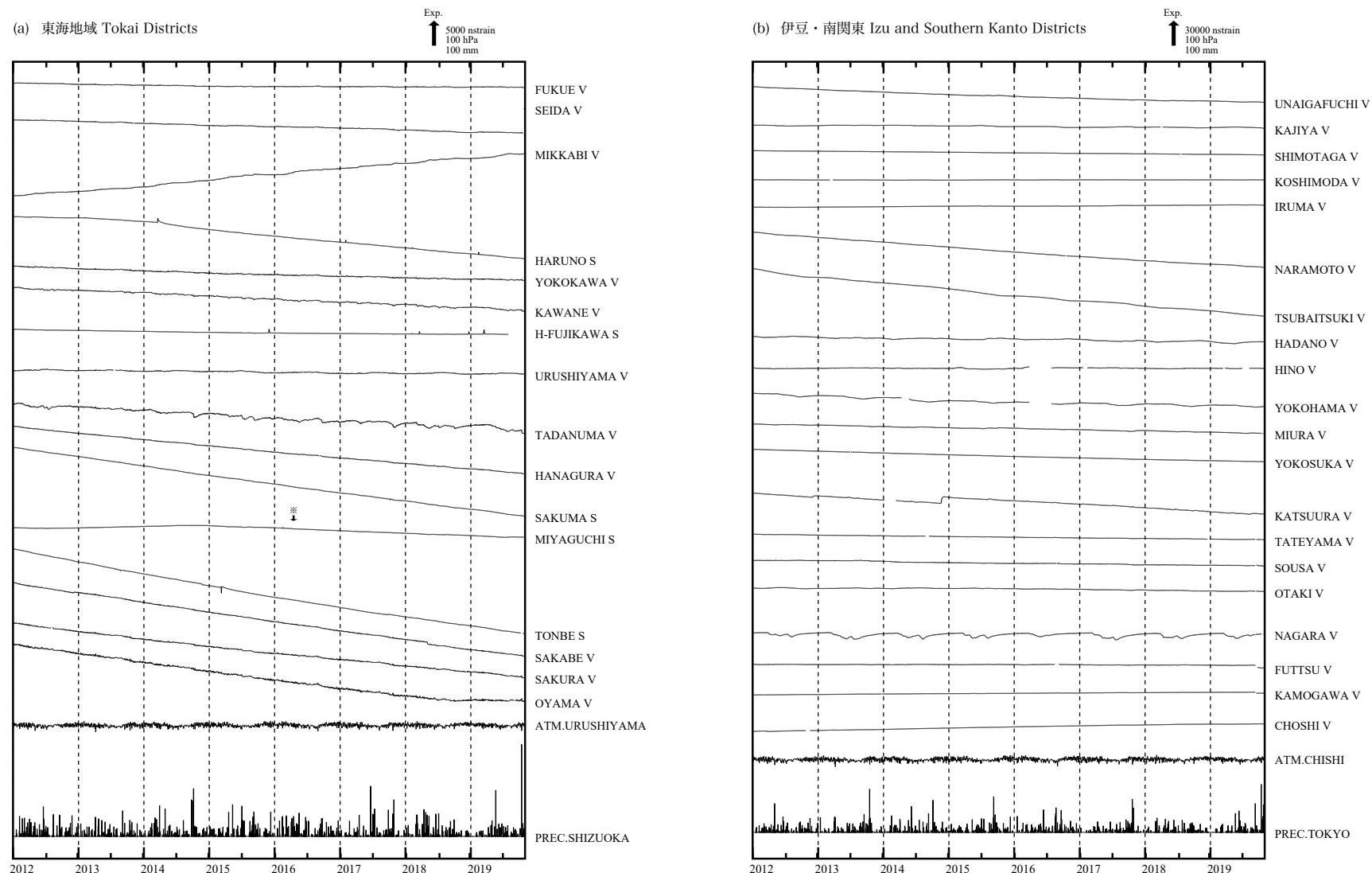
第2図(a), (b) 2012年1月以後の東海・伊豆・南関東地域における区域別体積ひずみ（V）及び面積ひずみ（S）の変化（日平均値）。各図下部に区域を代表する気圧変化と降水量を示す。
