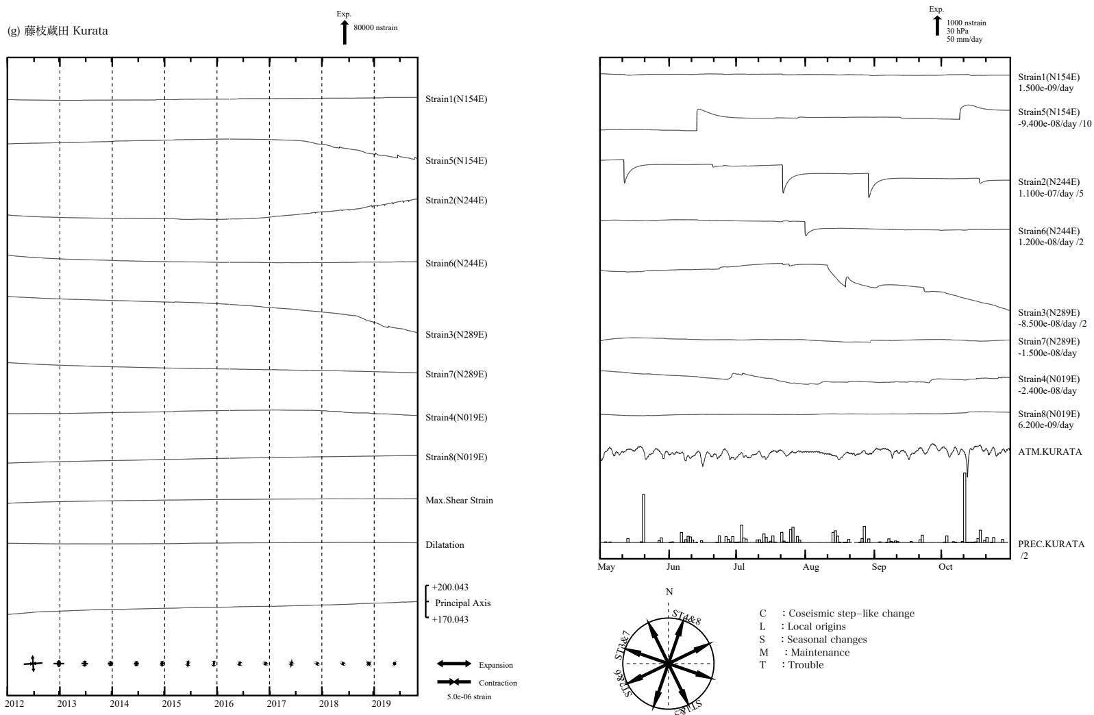
第4図(g) 左：2012年1月以後の多成分ひずみ計変化（日平均値）。主ひずみ・最大せん断ひずみ・面積ひずみは各方向成分から計算されている。右：2019年5月～10月の多成分ひずみ計変化（時間値：気圧・潮汐・地磁気補正した値）。各図下部に気圧変化と降水量を示す。
