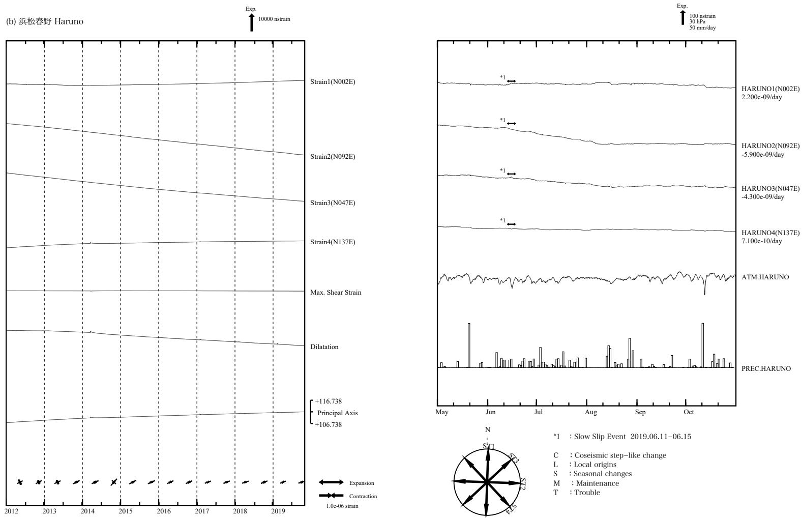
第4図(b) 左：2012年1月以後の多成分ひずみ計変化（日平均値）。主ひずみ・最大せん断ひずみ・面積ひずみは各方向成分から計算されている。右：2019年5月～10月の多成分ひずみ計変化（時間値：気圧・潮汐・地磁気・降水補正した値）。各図下部に気圧変化と降水量を示す。
