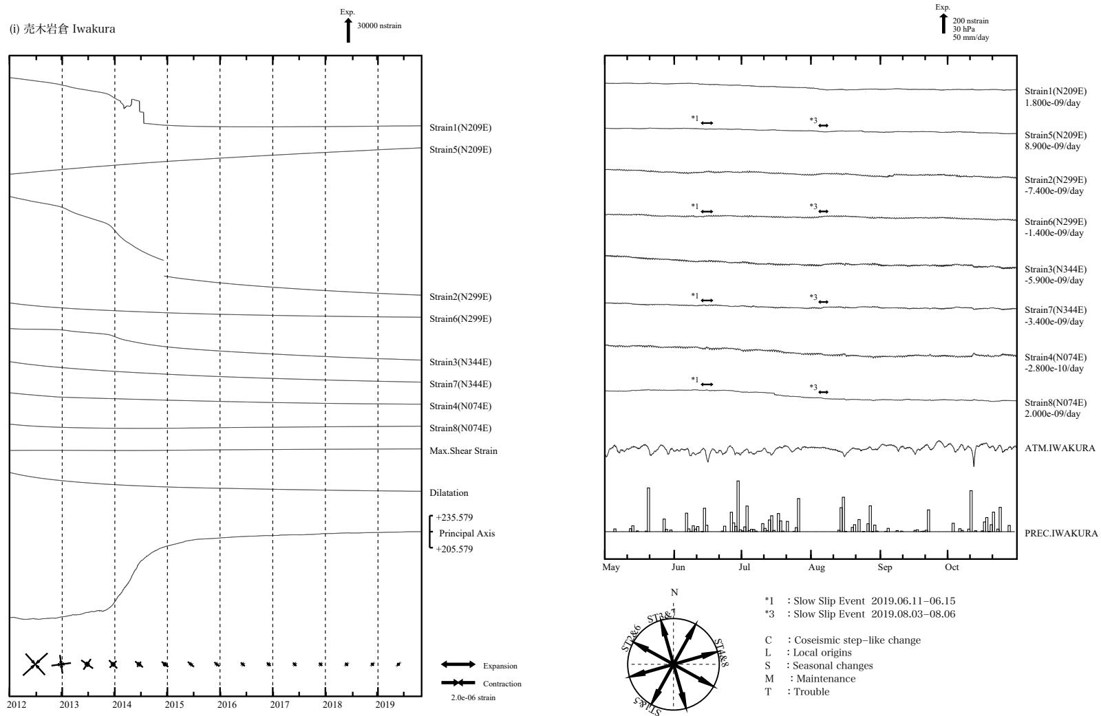
第4図(i) 左：2012年1月以後の多成分ひずみ計変化（日平均値）。主ひずみ・最大せん断ひずみ・面積ひずみは各方向成分から計算されている。右：2019年5月～10月の多成分ひずみ計変化（時間値：気圧・潮汐・地磁気補正した値）。各図下部に気圧変化と降水量を示す。
