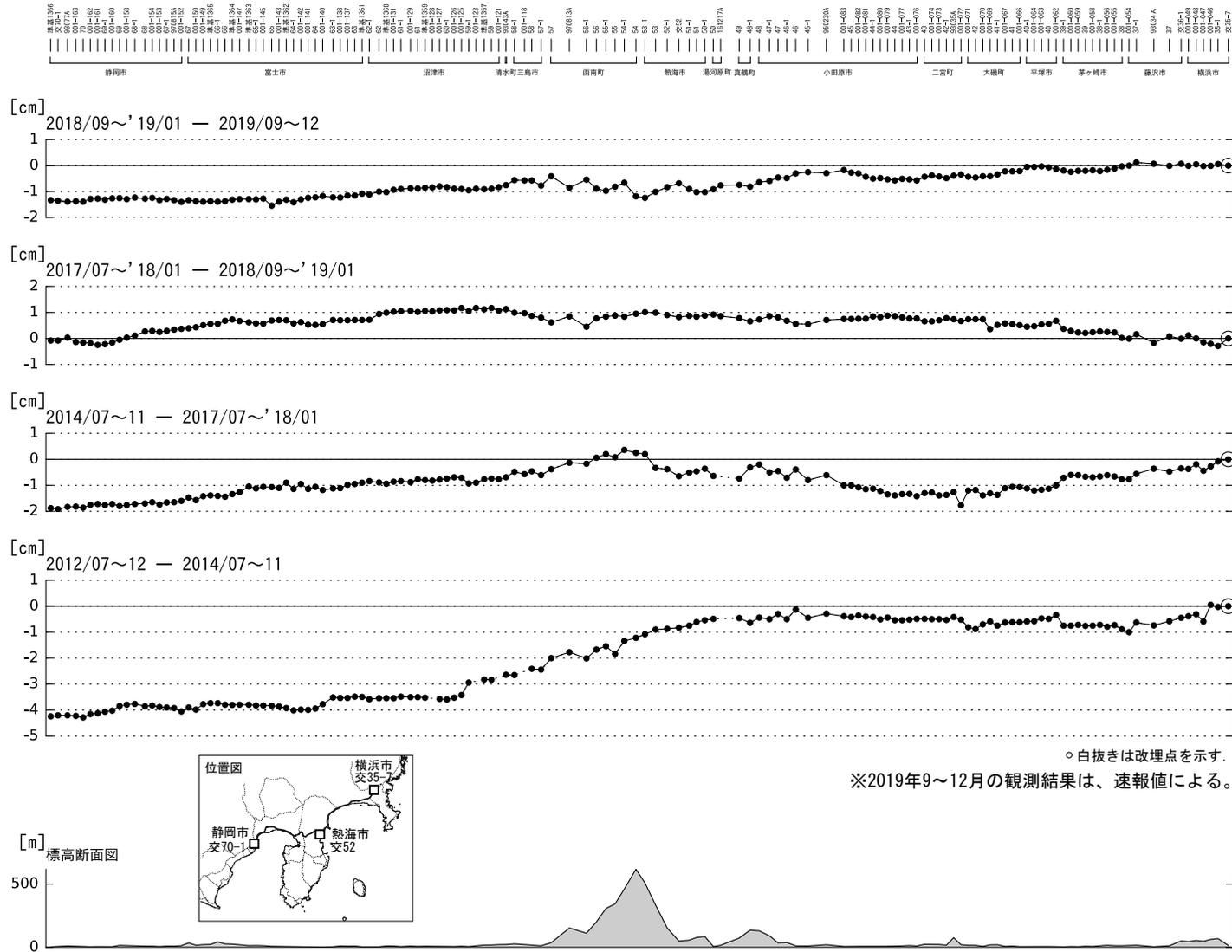
第14図 水準測量による静岡市～熱海市～横浜市間の上下変動
