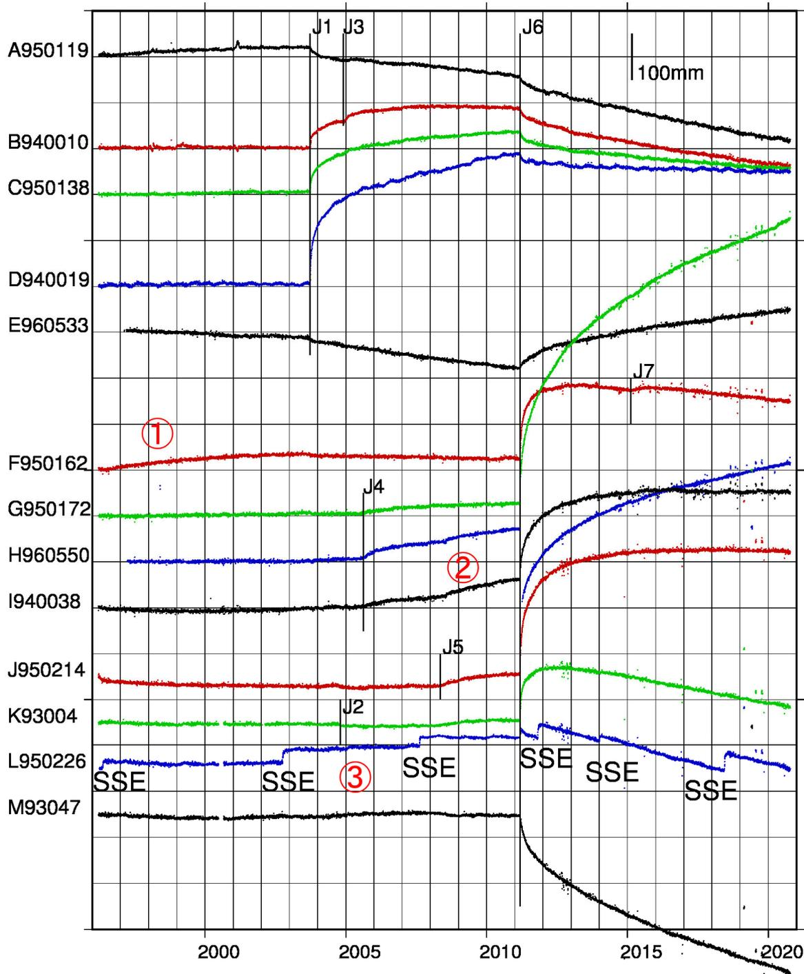
第 2a 図 プレート沈み込み方向の位置変化（東日本；1996 年から 2020 年 10 月）
