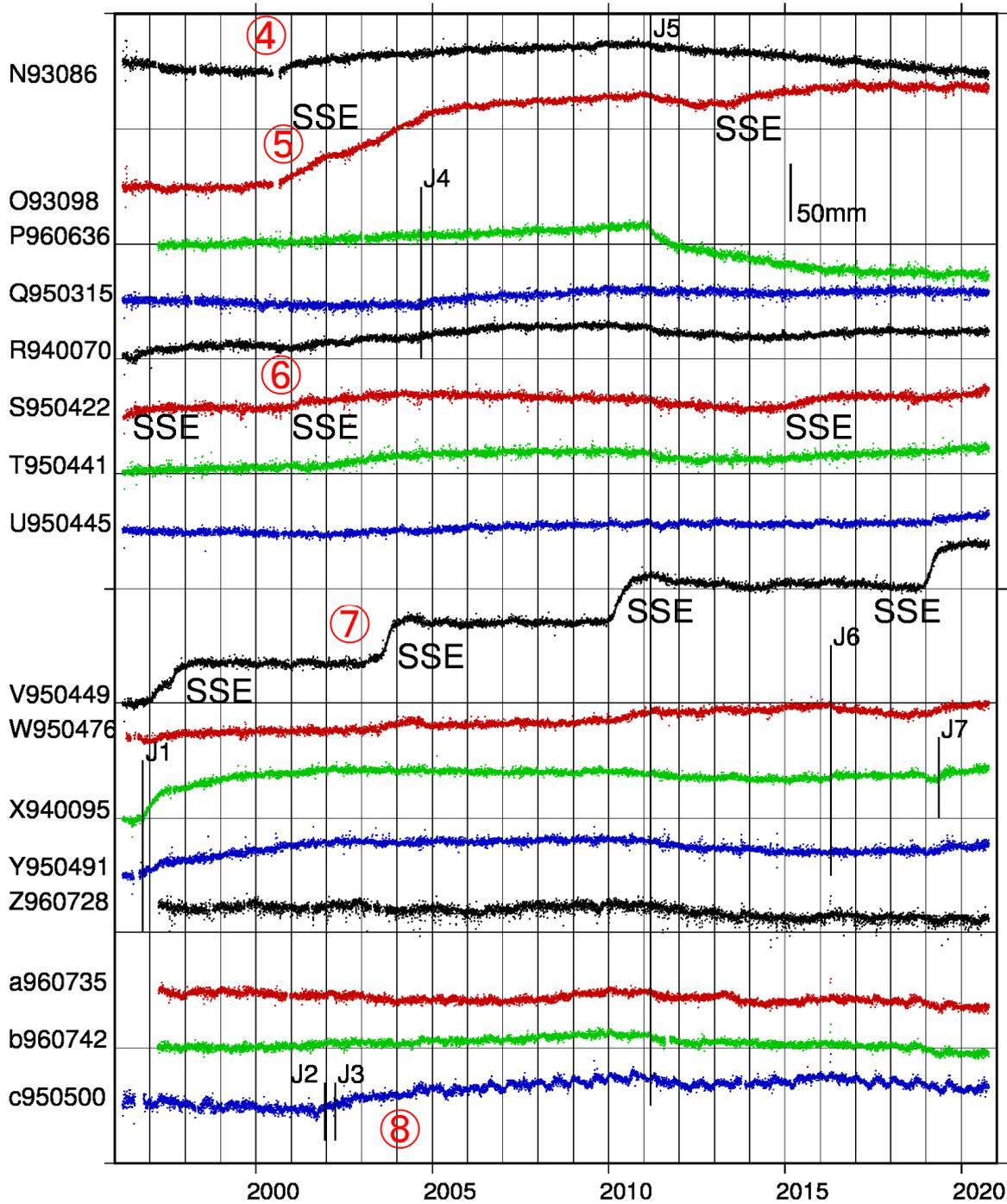
第 2b 図 プレート沈み込み方向の位置変化（西日本；1996 年から 2020 年 10 月）
