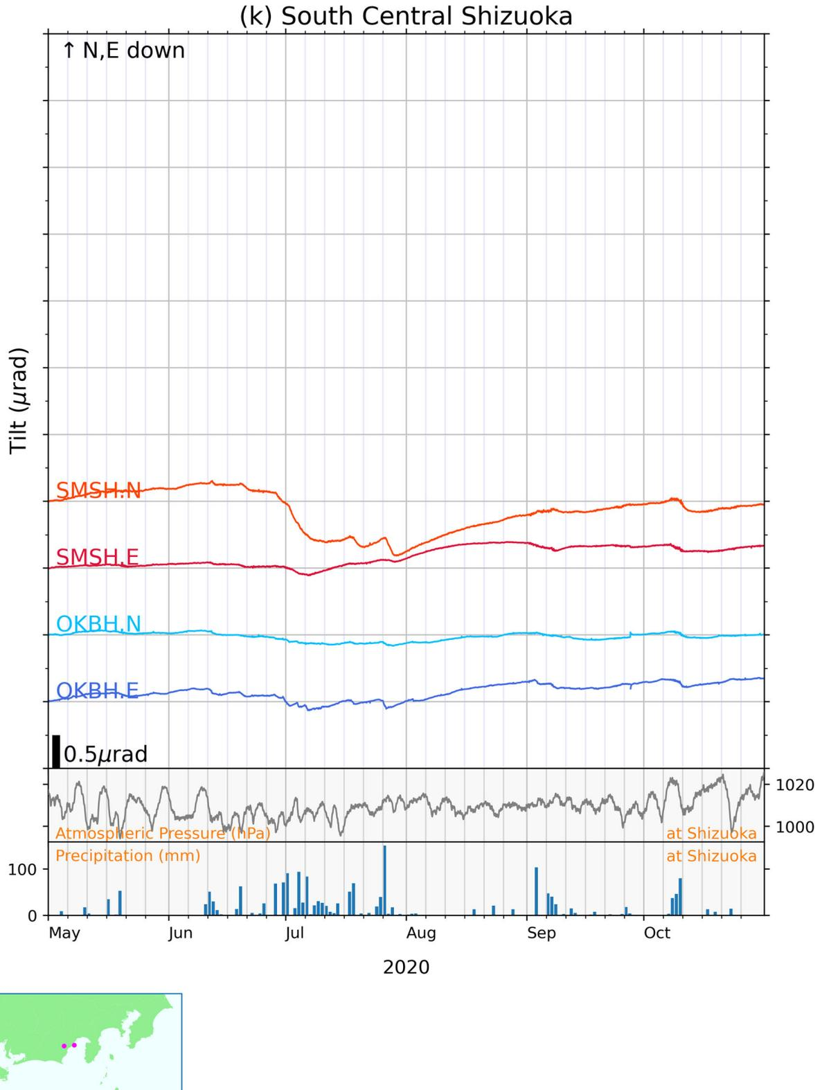
第 2 図 (k) 傾斜の時間値記録（静岡中南部）及び気圧・日雨量（静岡）.
