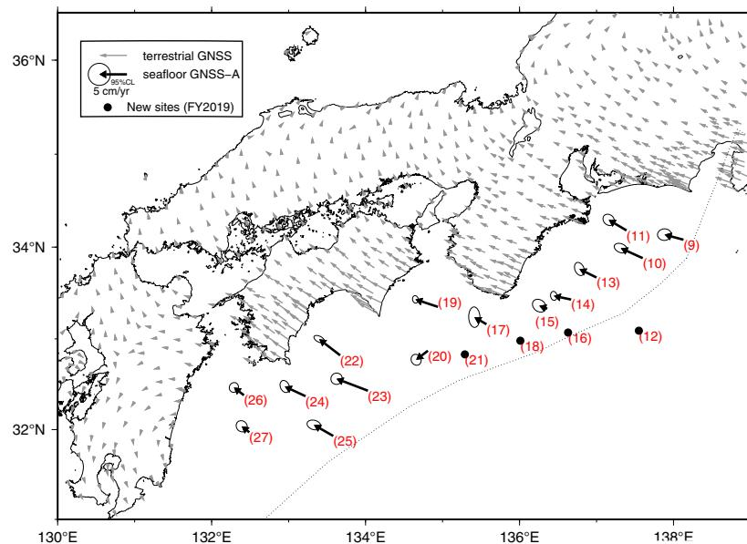
第1図 南海トラフ沿いの海底の水平地殻変動
