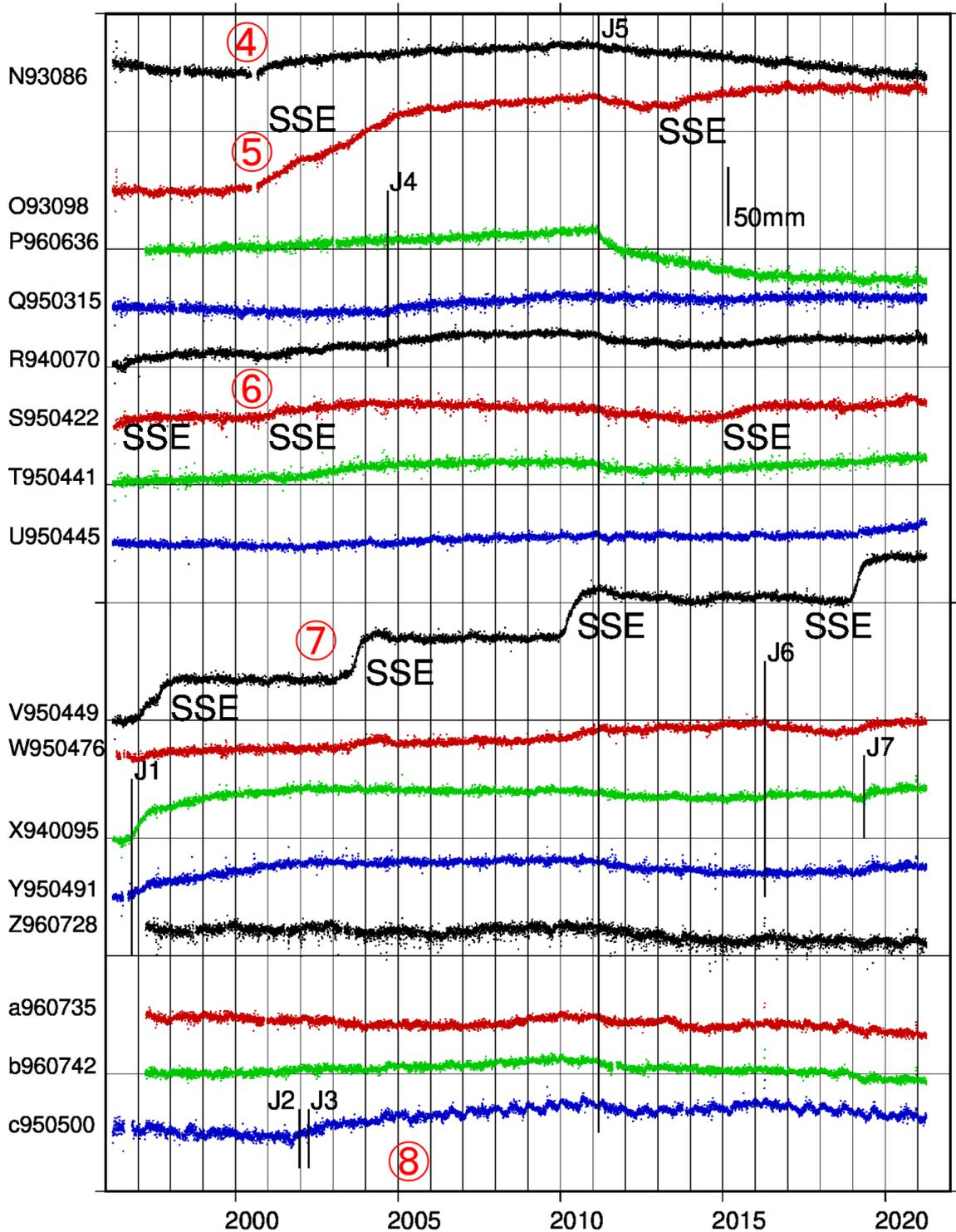
第 2b 図 プレート沈み込み方向の位置変化（西日本；1996 年から 2021 年 4 月）
