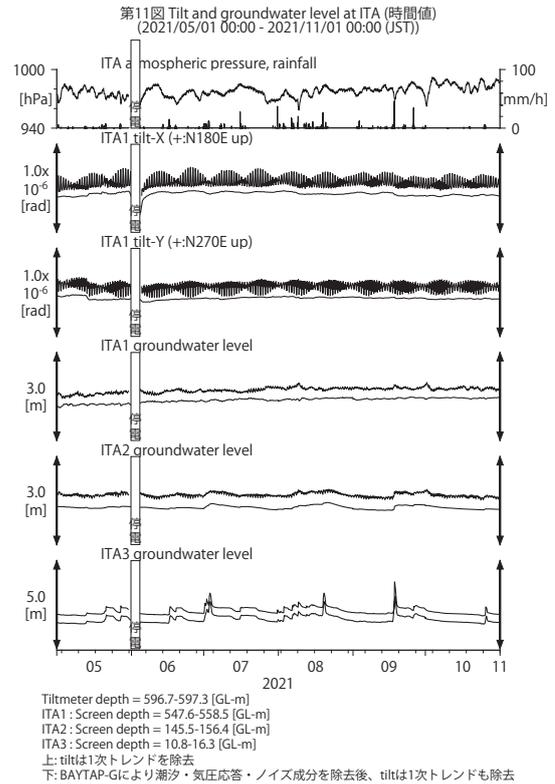
第 11 図 ITA における傾斜・地下水位観測結果 (2021 年 5 月～2021 年 10 月)
