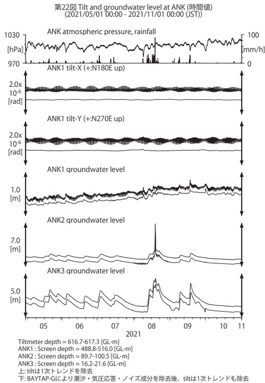
第 22 図 ANK における傾斜・地下水位観測結果 (2021 年 5 月～2021 年 10 月)
