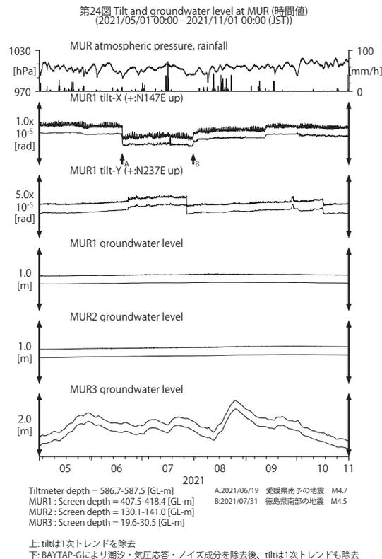
第 24 図 MUR における傾斜・地下水位観測結果 (2021 年 5 月～2021 年 10 月)
