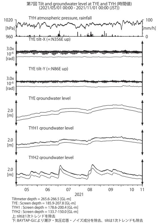
第 7 図 TYE および TYH における傾斜・地下水位観測結果 (2021 年 5 月～2021 年 10 月)
