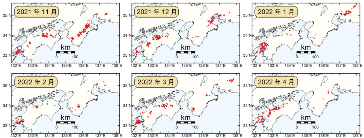
第 1 図 西南日本で発生した深部低周波微動及び深部超低周波地震<sup>4)</sup>の月別震央分布. 赤丸が当該期間の微動の震央を表す. この震央はエンベロープ相関・振幅分布ハイブリッド法<sup>6)</sup>及びクラスタリング処理<sup>7)</sup>によって 1 時間毎に自動処理された微動分布の重心である. 青菱形は深部超低周波地震の震央を示す.
