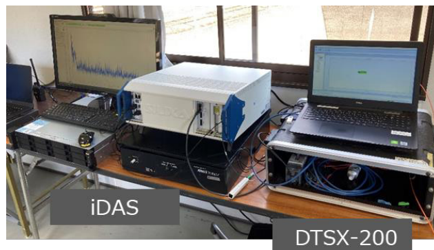
第 2 図 光ファイバセンサの計測器 (インタロゲータ) DAS : 分布型音響センサ (左), DTS : 分布型温度センサ (右)。
