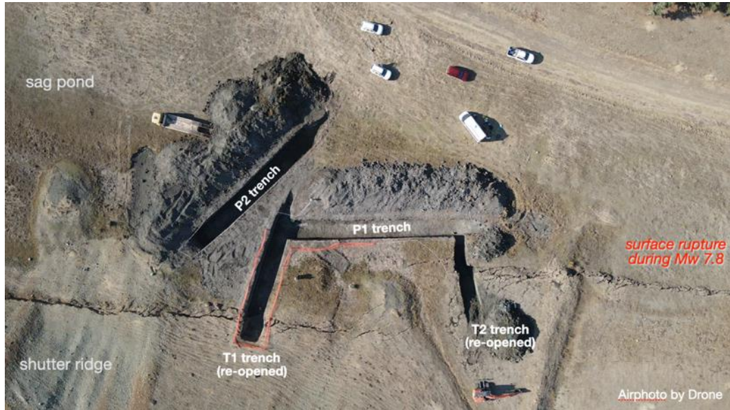
第 3 図 カルタル地点における 3D トレンチ調査位置と 2023 年地表地震断層. T1 トレンチと T2 トレンチは, 2014 年に掘削したトレンチを再掘削したもの.
