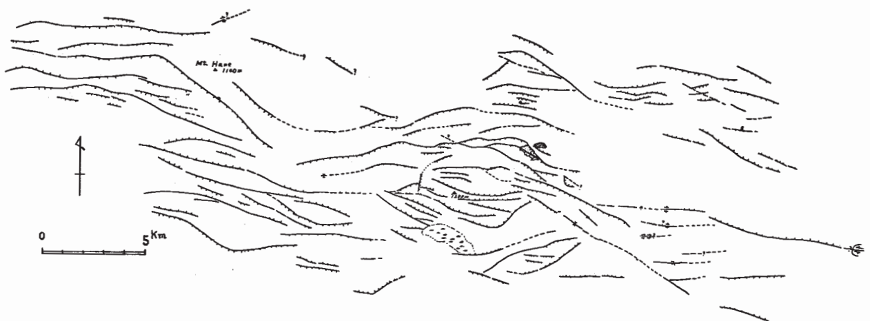
第4図 大分県中部地域に発達する活断層系 Fig. 4 Active faults system in the central part of Oita Prefecture.
