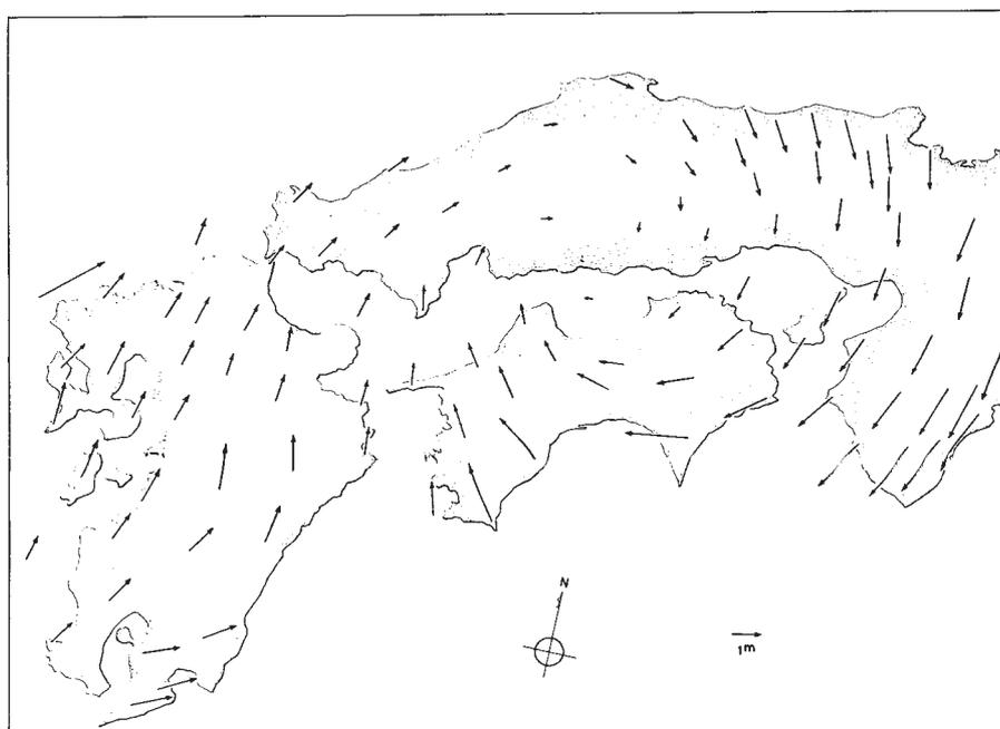
第4図 middle から new にかけての各三角点の水平変動
