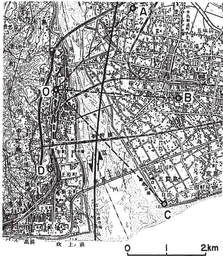
第1図 富士川断層と光波測量測線
