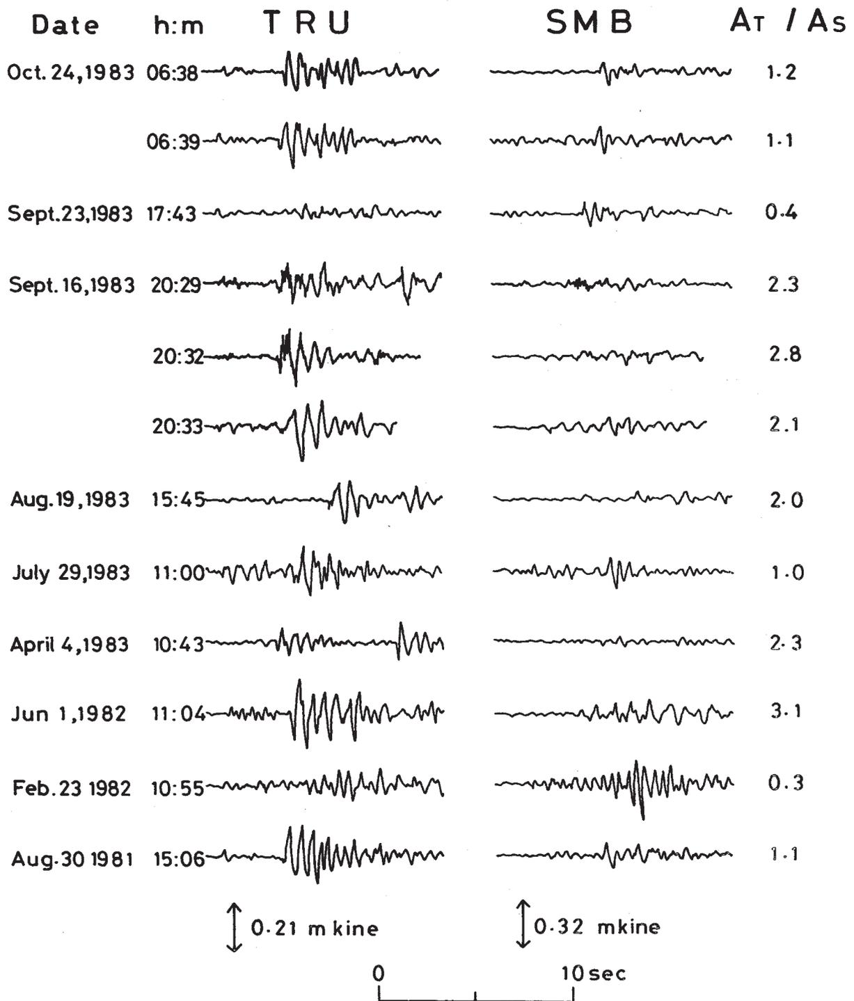
第 6 図 富士山直下で発生した地震の TRU と SMB の波形の比較例
